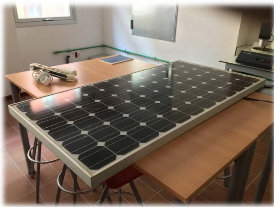
Ilustración 37. Parte frontal del panel desmontado.
