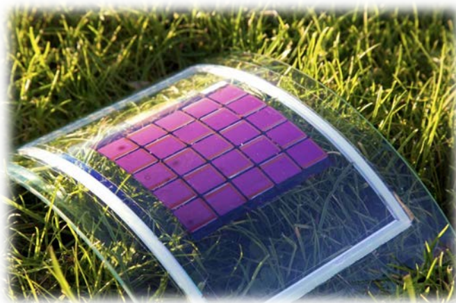
Ilustración 13. Célula solar de tipo orgánico.
