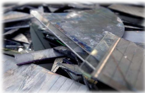
Ilustración 32. Fragmentos de vidrio procedentes de un panel fotovoltaico.
