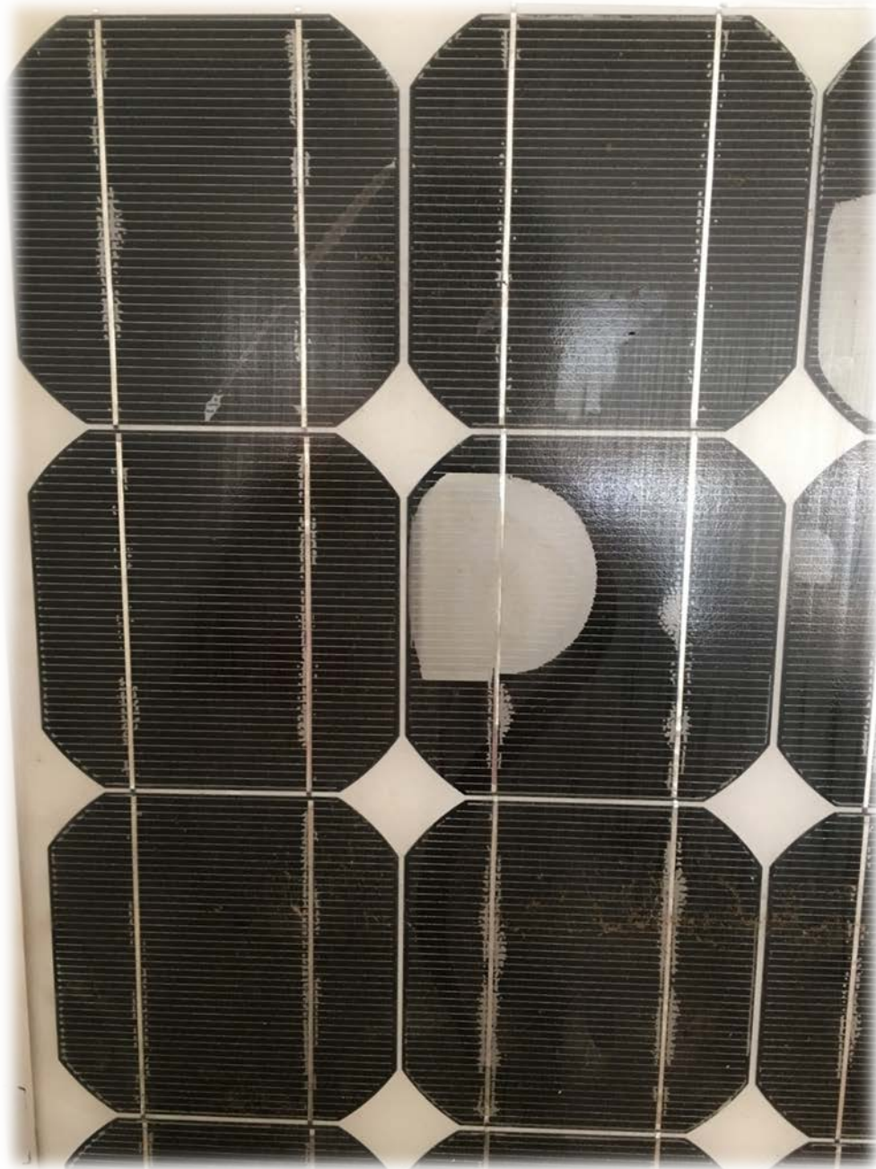
Ilustración 41. Placa de vidrio intacta.
