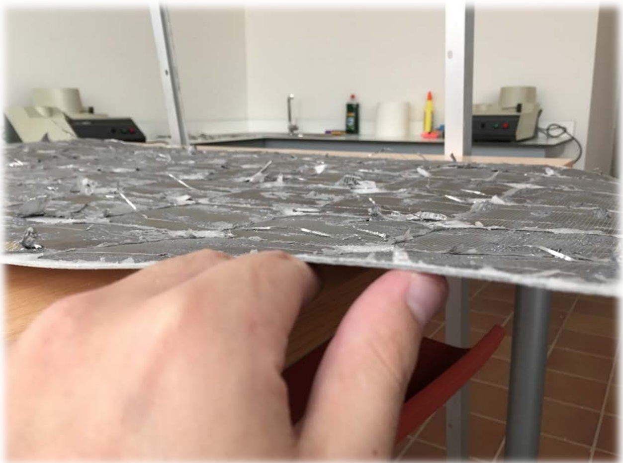
Ilustración 50. Vista de perfil de la lámina de células y Tedlar tras la extracción del vidrio.
