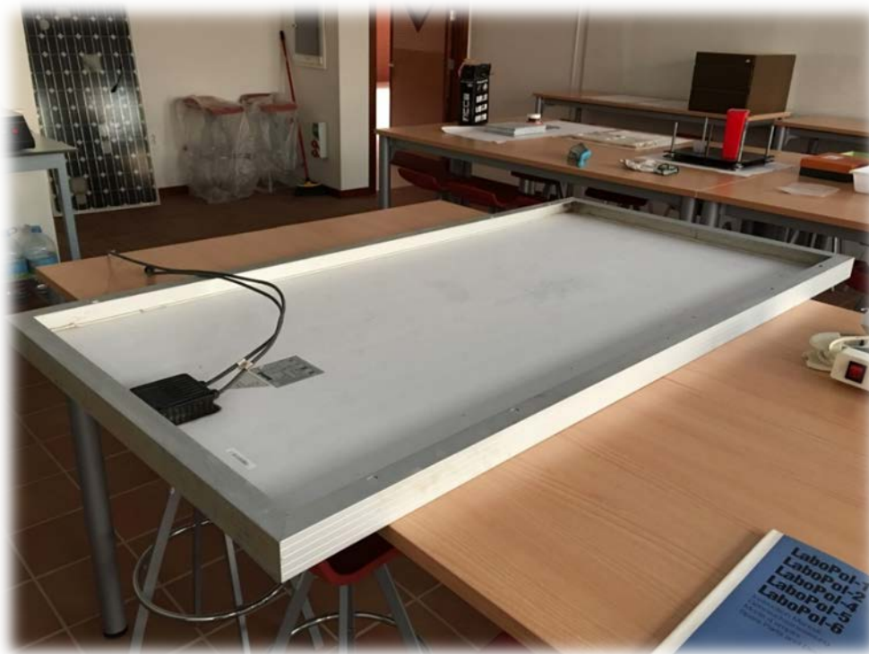
Ilustración 38. Parte posterior del panel desmontado.
