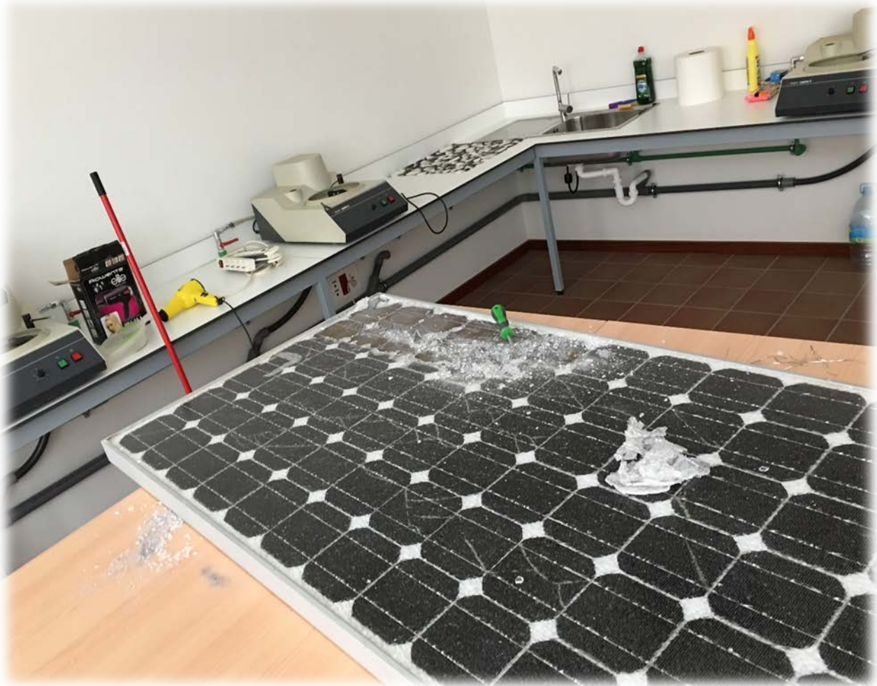
Ilustración 46. Proceso de extracción de los fragmentos de vidrio (I).
