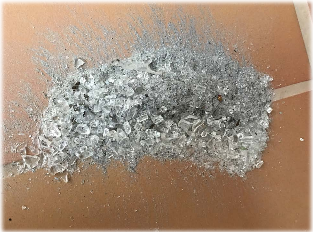
Ilustración 49. Recogida de fragmentos de vidrio, EVA y restos de polvo de silicio.
