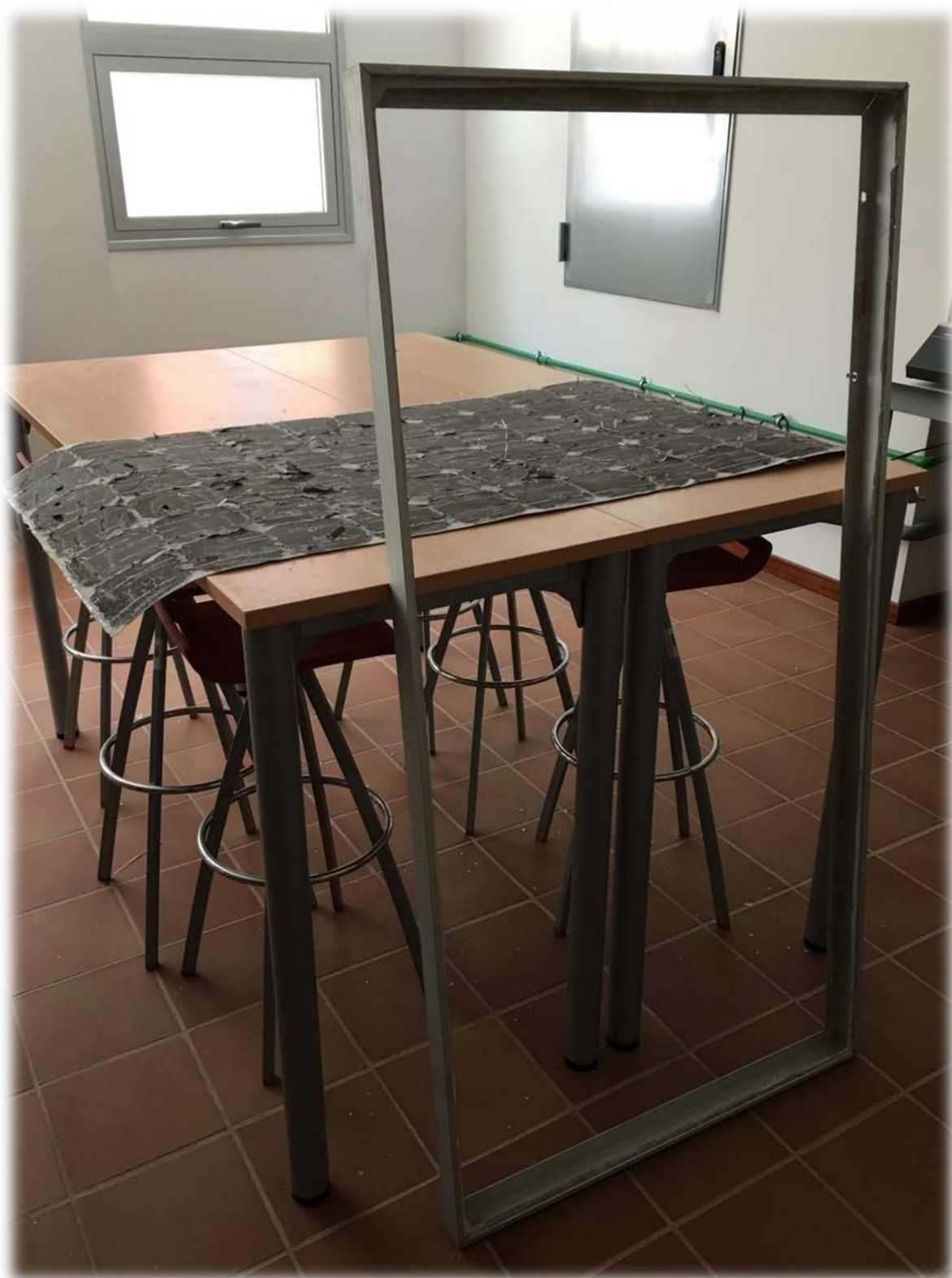
Ilustración 52. Marco de aluminio y capa de Tedlar una vez separados.
