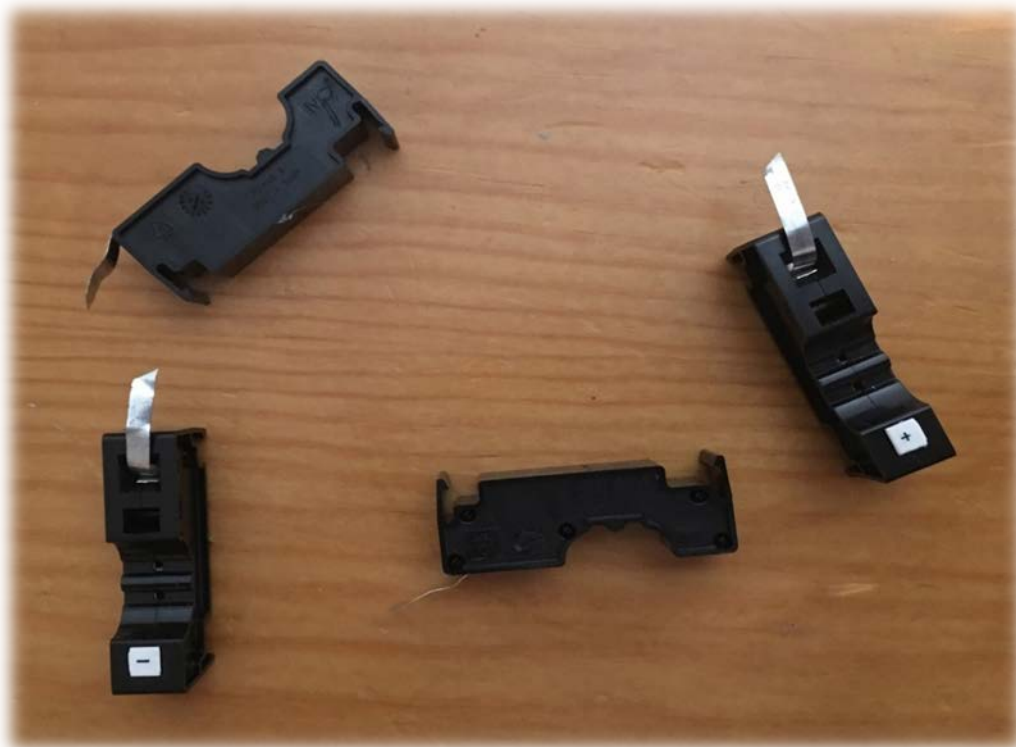
Ilustración 56. Soportes de diodos.
