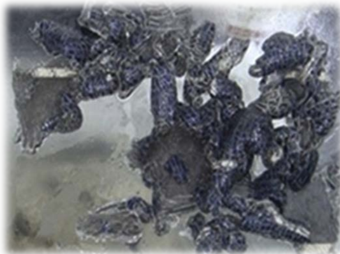
Ilustración 28: Hinchazón del EVA por el uso de disolventes.
