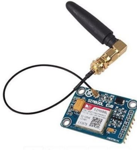
Figura III.6: Módulo GSM SIM800L EVB. Fuente: electronilab.co
