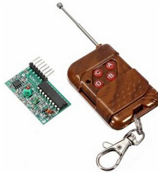
Figura III.10: Emisor-Receptor por RF con mando. Fuente: prometec.net
