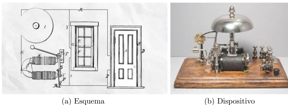
Figura I.1: Esquema eléctrico y sistema de alarma de Pope. Fuente: rodych.es
