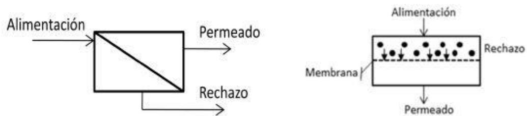
**Figura 1.2.** Esquema de la filtración frontal (Saavedra y Romero, 1999).
