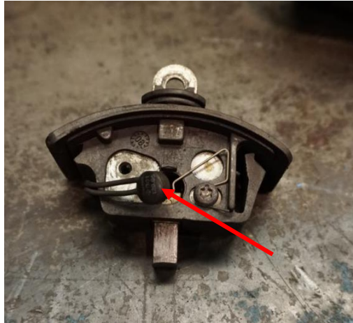
Figura 13. Sensor térmico Compresor ERVOR
