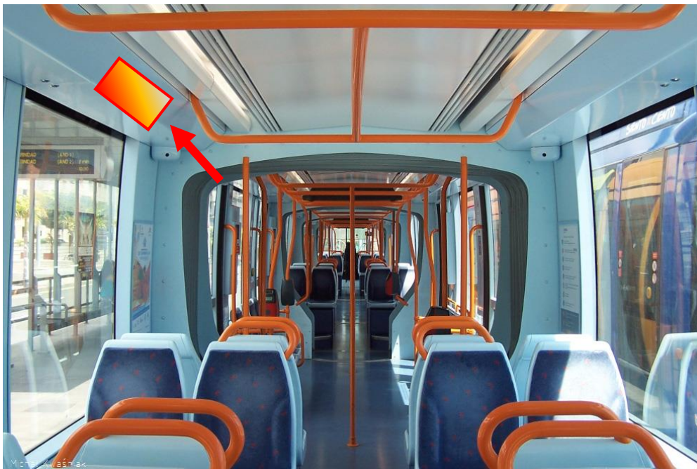
Figura 29. Ubicación PLC y protecciones eléctricas bajo capota
