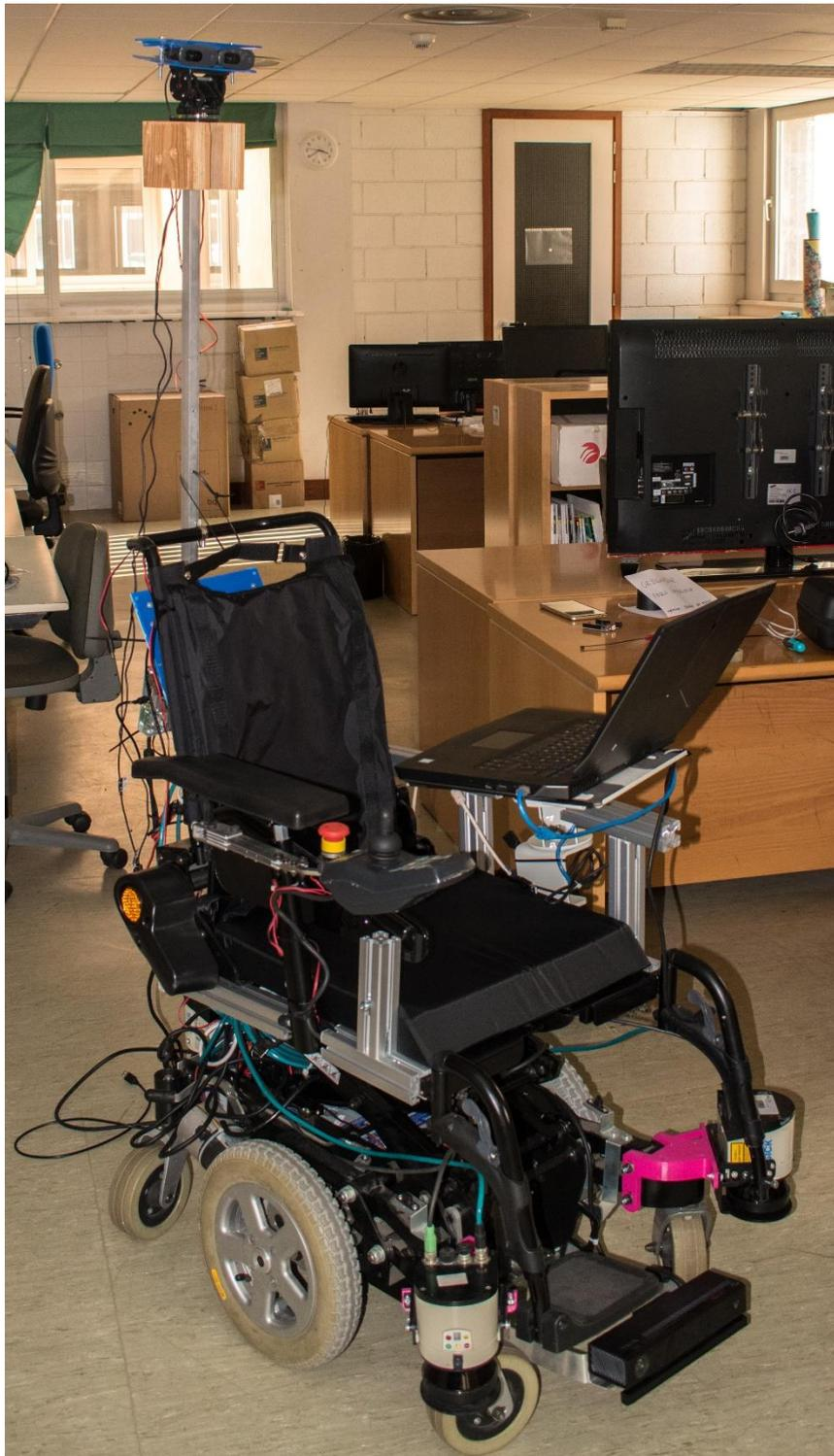
Figura 18: Componentes montados en la silla de ruedas
