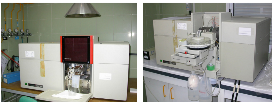
Foto 7 y 8: Espectrofotómetro de absorción atómica de llama y Espectrofotómetro de absorción atómica con cámara de grafito.
