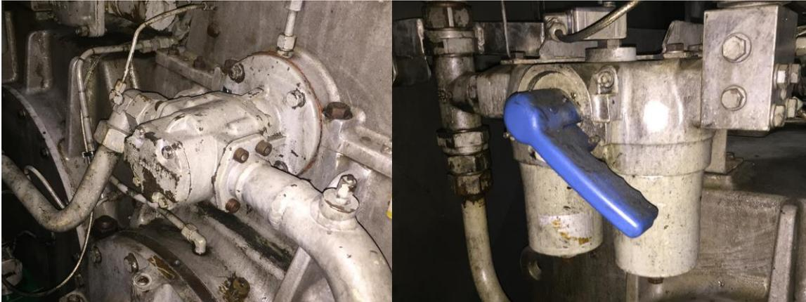
*Ilustración nº 42: Bomba de Lubricación y Filtros Reductora Reintjes VLJ 6831.*
