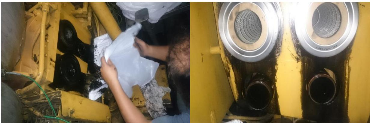
*Ilustración nº 35: Sustitución filtros de aceite Vokes Simplex.
