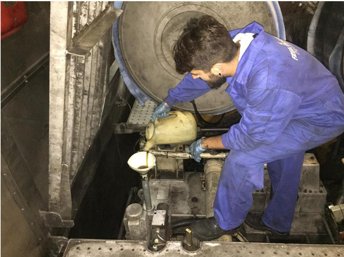
*Ilustración nº 44: Reposición de aceite a Reductora Reintjes 6831.*
