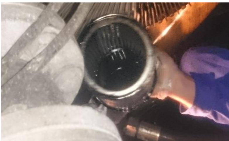
*Ilustración nº 36: Comprobación de la Rejilla del Cárter.
