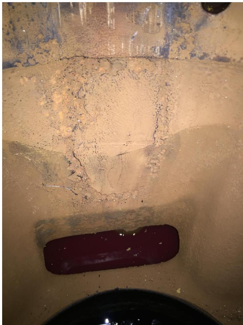
*Ilustración nº 18: Cavitación en el Bloque Motor de Caterpillar 3618.
