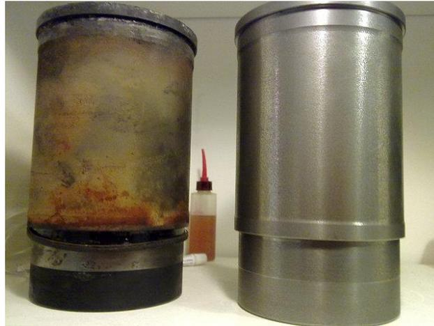
Ilustración n° 15: Desgaste Corrosivo en camisa.
