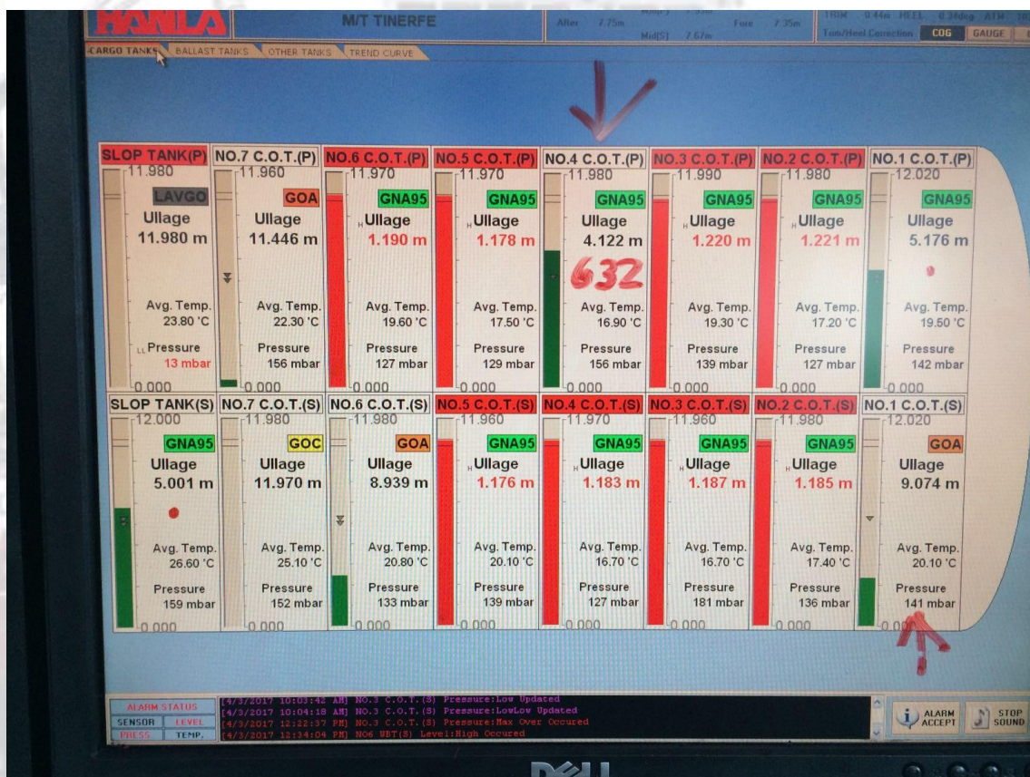
Imagen de la pantalla de monitorización continua a tiempo real de las sondas de vacío. (Archivo de Alfonso Fortuny)
