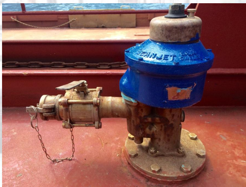
Imagen de la máquina de limpieza SCANJET del TC8E con su válvula de admisión. (Archivo Alfonso Fortuny)
