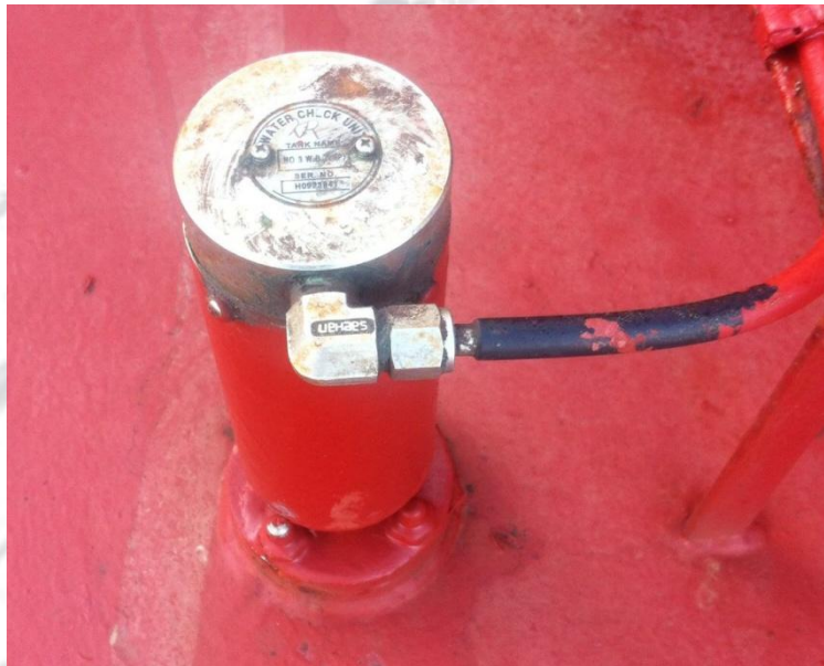
Imagen del sensor de lastre del tanque TL6B (Archivo: Alfonso Fortuny).
