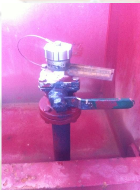
Imagen del tubo de sonda del tanque TC4B (Archivo: Alfonso Fortuny).
