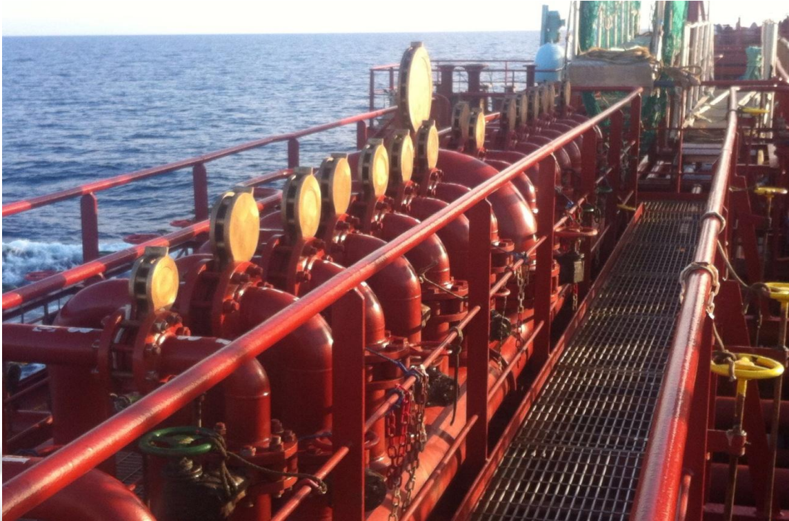
Imagen del colector de babor, con las agrupadas de cada tanque. (Archivo: Alfonso Fortuny)
