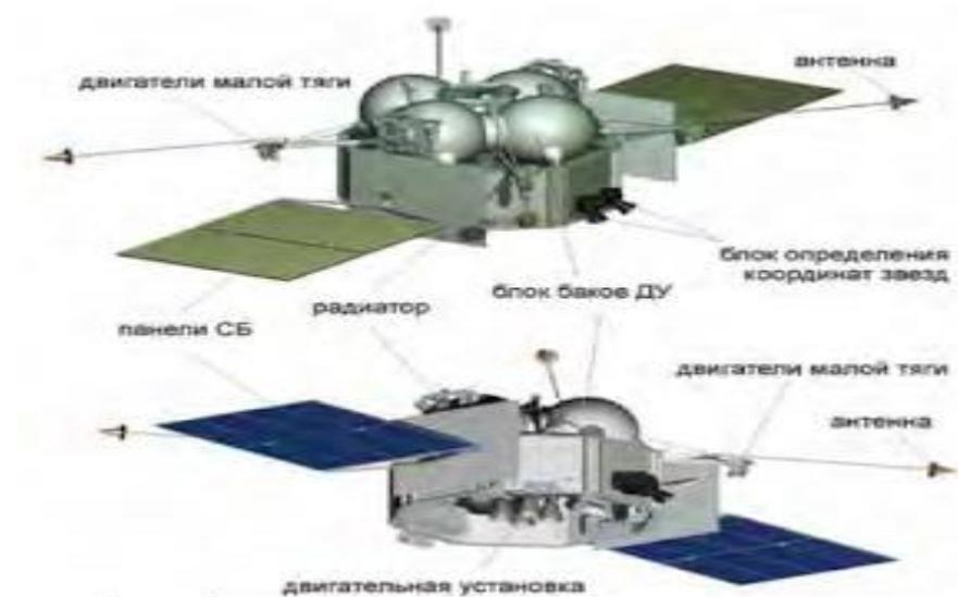
Ilustración 52: Detalle de la plataforma Flagman (NPO Lávochkin).
