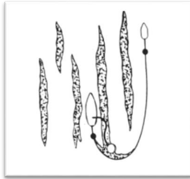
Ilustración 41 Formación en "J" mediante dos embarcaciones; Fuente: http://www.gobiernodecanarias.org/dgse/descargas/pecmar/anejo_09/Doc_03%20Barreras.pdf
