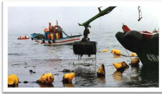
Ilustración 50 Cazo hidráulico recogiendo hidrocarburo pesado; Fuente: http://www.cetmar.org/documentacion/imagenes/EquiposFortuna.jpg
