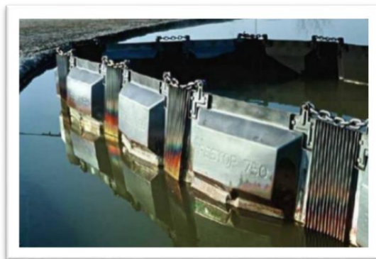
Ilustración 36 Barreras ignífugas; Fuente:
