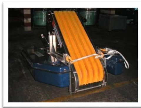
Ilustración 47 Skimmer de cepillos; Fuente: http://www.salvamentomaritimo.es/wp-content/files_flutter/1322477910Web_EspecificTecnicasSkimmers.pdf
