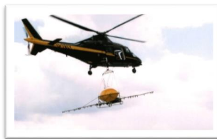
Ilustración 54 Helicóptero con sistema de rociado portátil de dispersante; Fuente: http://img.nauticexpo.es/images_ne/photo-g/32656-9761353.jpg
