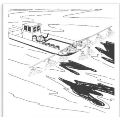
Ilustración 55 Buque descargando dispersante; Fuente: http://www.gobiernodecanarias.org/dgse/descargas/p ecmar/anejo_09/Doc_05%20Dispersantes.pdf
