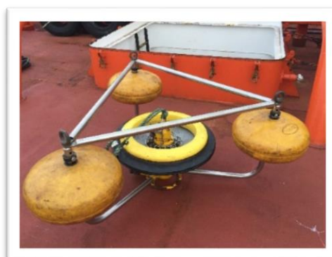
Ilustración 46 Skimmer de vertedero; Fuente: Propia
