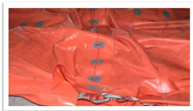
Ilustración 44 Conexión “Noruega” ; Fuente: https://repositorio.unican.es/xmlui/bitstream/handle/10902/3935/Pablo%20Casado%20Ferreiro.pdf?sequence=1
