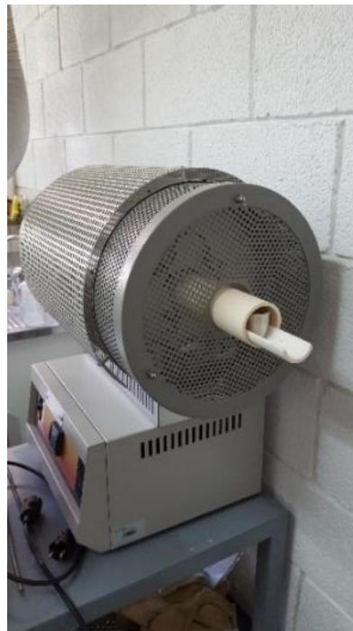
Fig. 2.10: Horno, bandeja soporte y crisol.
