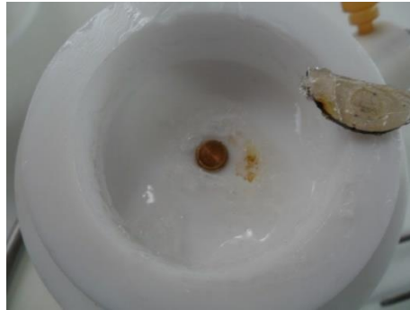
Fig. 2.9: Una marca producida por arco voltaico.
