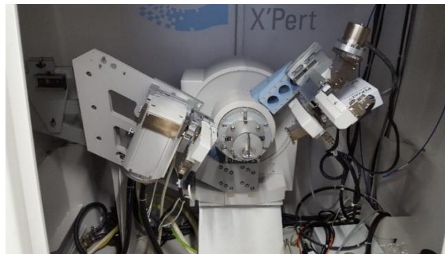
Fig. 3.2: Difractómetro Panalytical X'Pert Pro.
