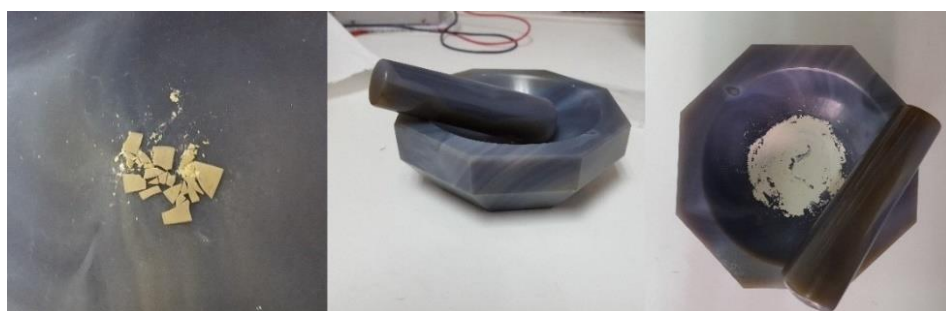
Fig. 3.1: (de izquierda a derecha) Trozos de muestra de Pz27 después de eliminar los electrodos depositados y trocearlo, mortero para la molienda y polvo de Pz27 .
