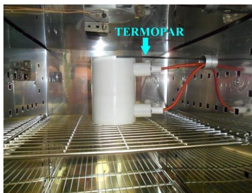
Fig. 2.4: Celda colocada en el interior de la estufa eléctrica.
