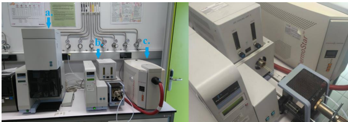
Figura 4.1: Conjunto del equipo de SAT de izquierda a la derecha: a) Perkin Elmer TMA; b) Pyris Diamond TGA/DTA (Perkin Elmer); c) espectrómetro de masas cuadrupolar mod. QMS 300 M3 (Thermostar).
