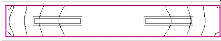
Altura del local: 3.500 m, Grado de reflexión: Techo 70.0%, Paredes 50.0%, Suelo 20.0%, Factor de degradación: 0.80
