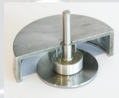
Figura 15. Geometría y tapa cubre Peltier.
