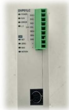
Ilustración 7. Módulo para célula de carga DVP-01LC
