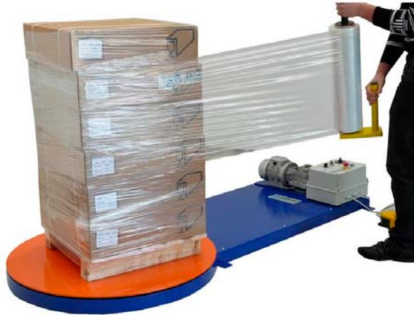
*Ilustración 2. Ejemplo de procedimiento de envoltura manual*
