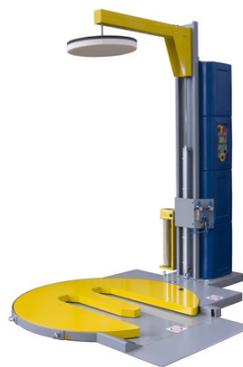
Ilustración 4. Máquina envolvente de base giratoria.
