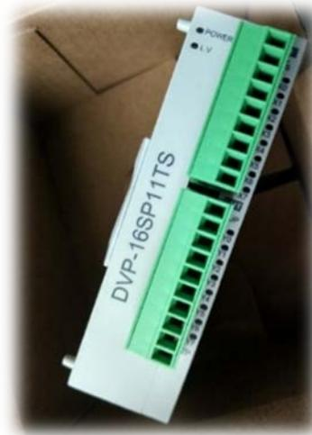
Ilustración 21. Módulo I/O Digitales DVP-16SP11TS
