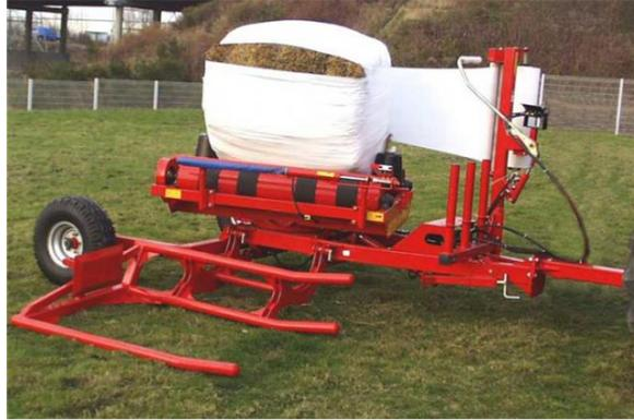
*Ilustración 13. Máquina envoladora de fardos*
