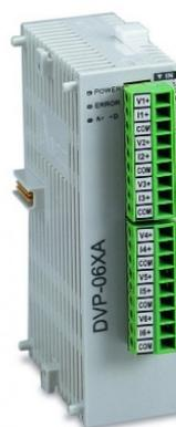
El sistema neumático del pre-estiraje de la máquina envolvente trabaja de forma analógica, por lo que necesitamos un módulo de entradas y salidas analógicas que acompañe al controlador lógico programable (PLC). En este caso por compatibilidad y precios se continuó optando por Delta Electronic Inc. siendo el módulo DVP-06XA, disponiendo de 4 entradas y 2 salidas analógicas, para realizar un control por voltaje o por intensidad.
