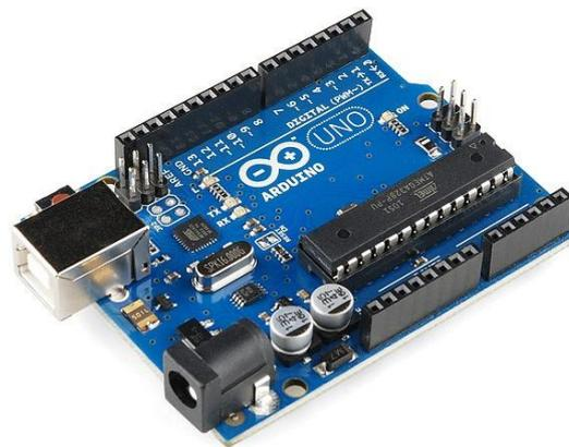
Figura 2.1. Plataforma de hardware libre Arduino Uno.
