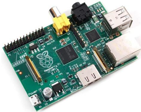
Figura 2.2. Raspberry Pi, PC de placa reducida.
