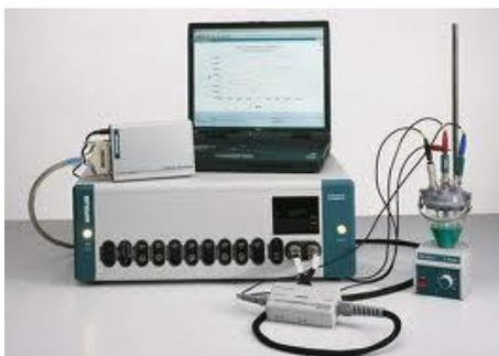
Figura II.20. Potenciostato-galvanostato AUTOLAB<sup>(R)</sup> modelo PGSTAT 30.
