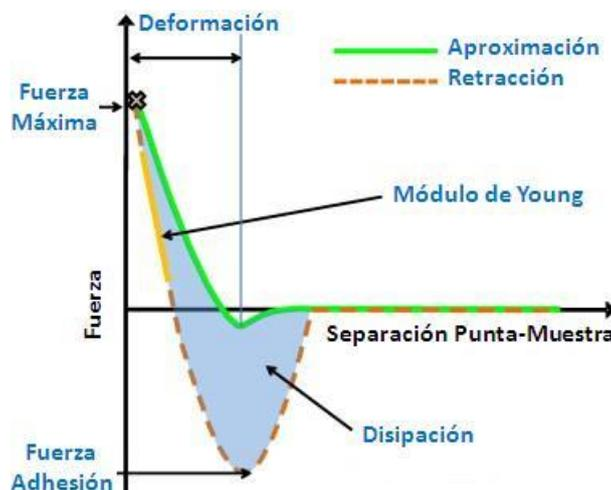
Figura II.15. Esquema que describe la interacción entre la sonda AFM y la superficie de la muestra para una fuerza dada o un desplazamiento del piezoeléctrico determinado.
