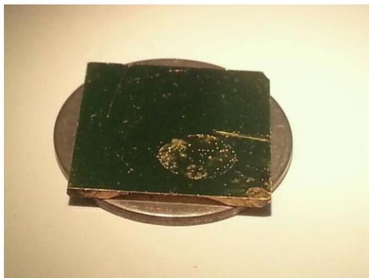
Figura II.29. Imagen de placa de Au Arrandee™ de 11 x 11 mm<sup>2</sup>.
