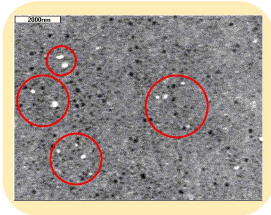
Figura IV.3.7. Imagen SEM de la superficie del HOPG tras la electrodeposición de melanina-hierro durante  $t_a = 24$  horas. Los círculos en rojo destacan la posición de gránulos brillantes analizados por EDX.
