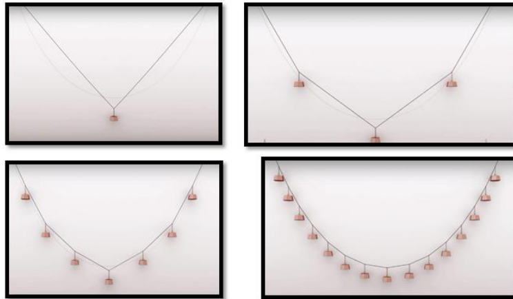
Figura 35. Explicación gráfica de cómo se forma la curva catenaria a partir de la unión de dos rectas: a medida que se añaden peses se va creando la curva, al ir acortando la distancia entre los puntos superiores se consiguen diferentes curvas
