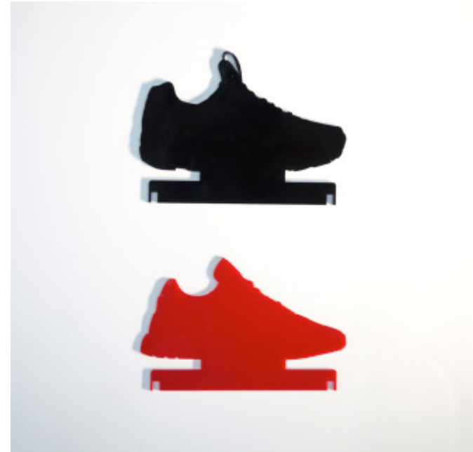
(18) Pieza troquelada a la cual se le añade el adhesivo con la ilustración
