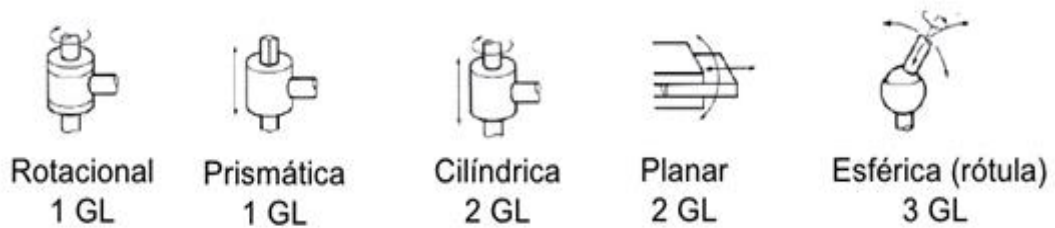
Figura 6. Tipos de articulaciones de un manipulador antropomórfico [8]
