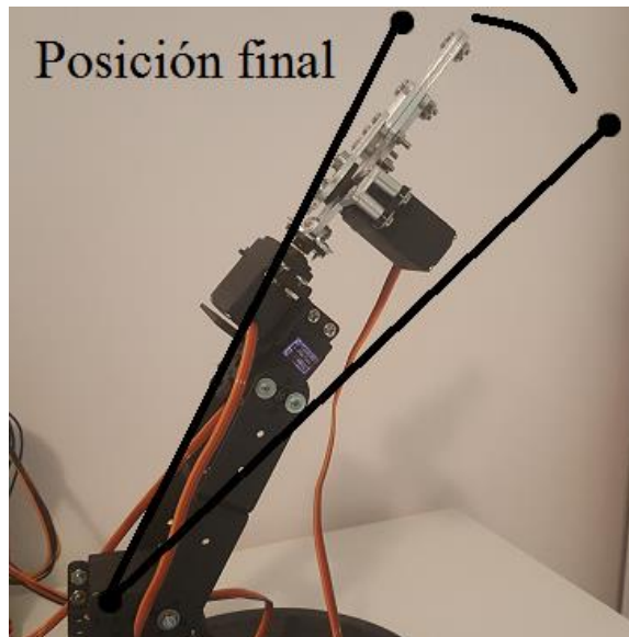
Figura 54. Variación tipo vaivén o resorte debido a la inercia del movimiento del brazo
