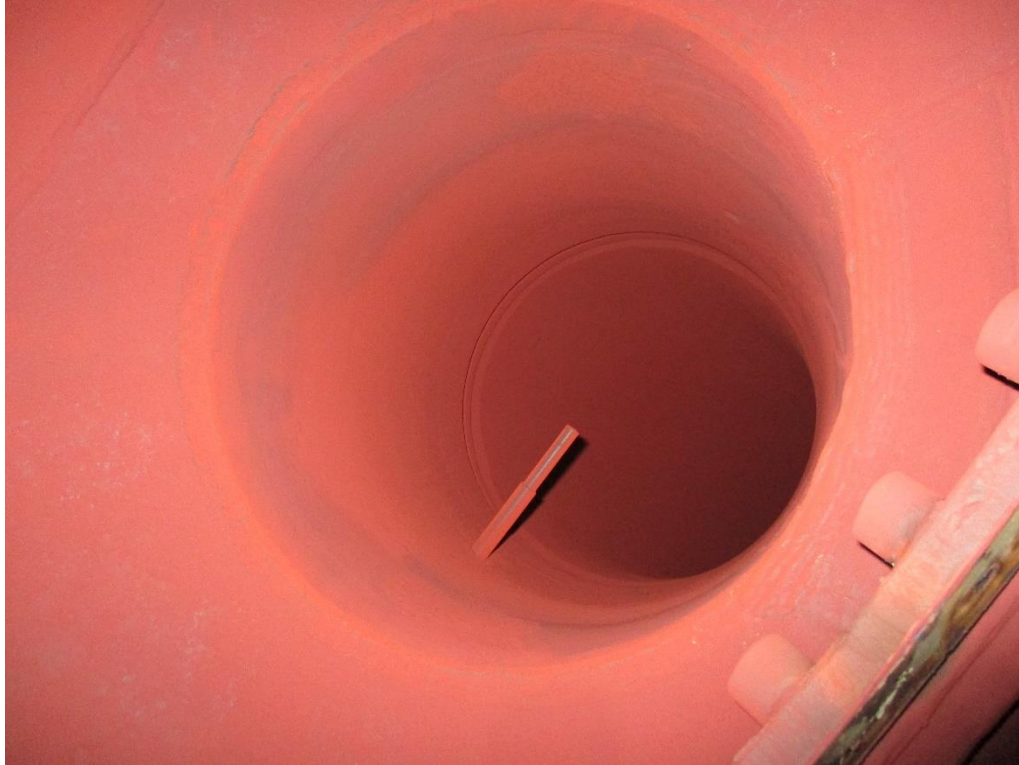
Imagen 1: Ejemplo de formación de una capa mixta de hematita y magnetita, en el interior del canal de salida de agua de alimentación, de un calentador tubular regenerativo de alta presión. El color rojo indica la presencia de hematita. Fuente: Cedido por una central termoeléctrica que emplea un tratamiento oxidante.
