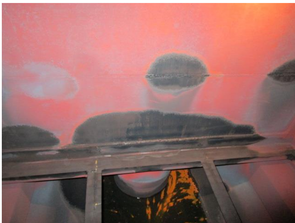
Imagen 5: Ejemplo de FAC en 2 fases, la magnetita (de color negro) se formó por el impacto de chorros de agua con bajo pH y baja concentración de O_2 . Dichos chorros de agua provienen de drenajes del ciclo agua-vapor, incluyendo los de un calentador tubular regenerativo de alta presión. Fuente: Cedido por una central termoeléctrica que utiliza el AVT(O).
