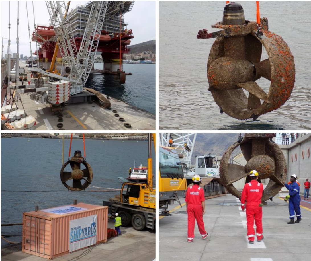
Ilustración 24 Extracción de propulsor azimutal de la plataforma Floatel Reliance. Dársena de Anaga, Puerto de Santa Cruz.
