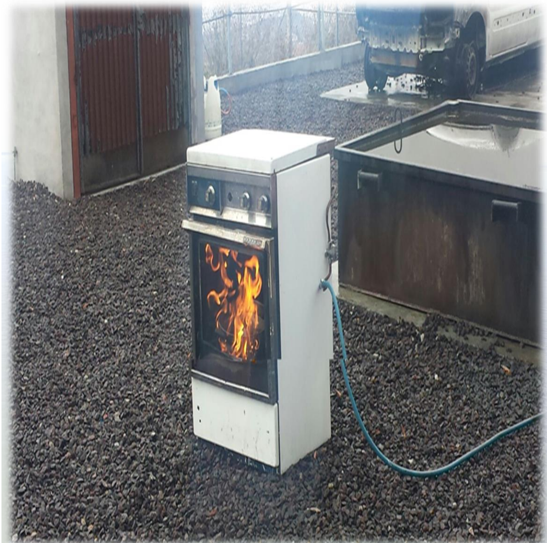
Ilustración 10. Horno ardiendo, objetivo aproximación hasta la llave de paso para su extinción. Fuente: Trabajo de campo.
