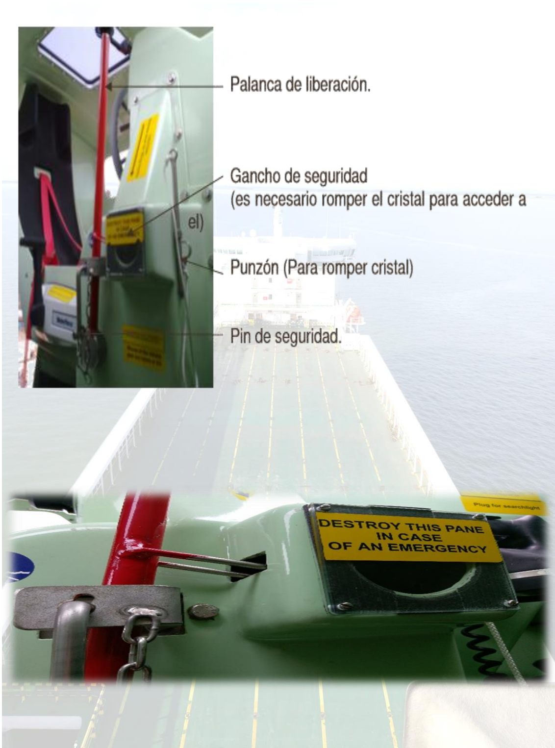
Ilustración 87. Elementos que componen el sistema de arriado de emergencia. Trabajo de campo.
