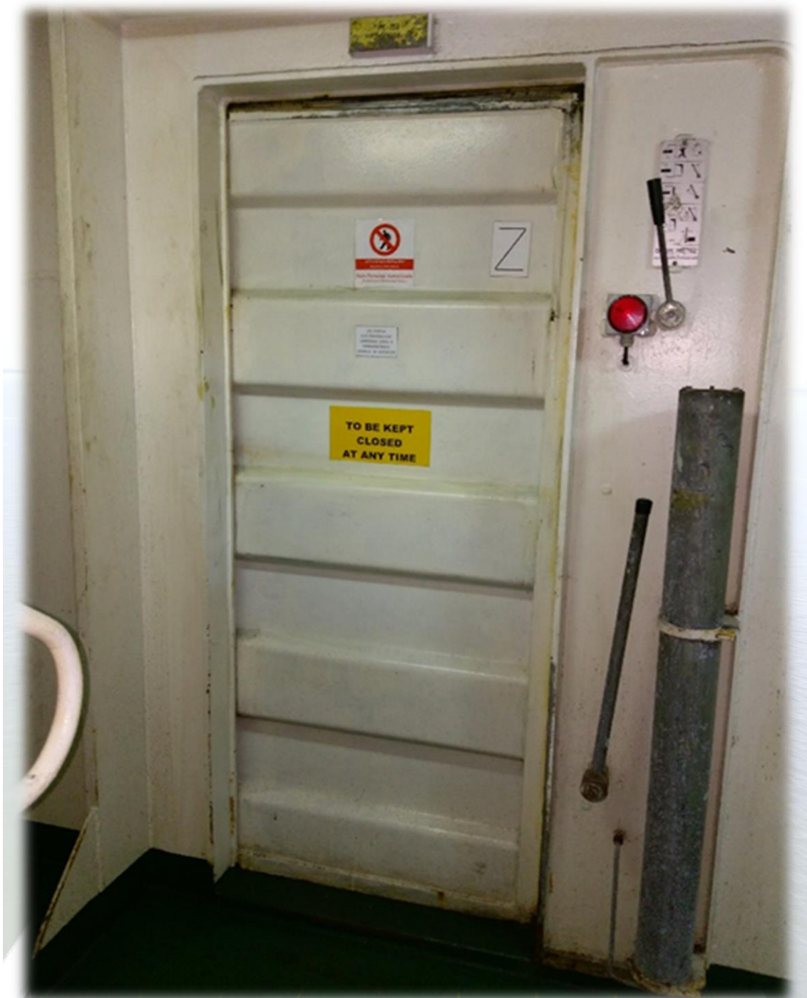
Ilustración 71. Puerta estanca situada en la cubierta 2. Trabajo de campo.
