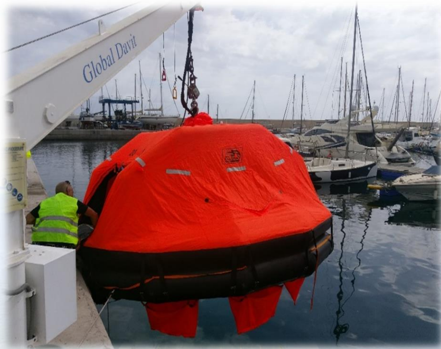
Ilustración 1285. Arriado con pescante, durante curso de botes no rápidos. Trabajo de campo.
