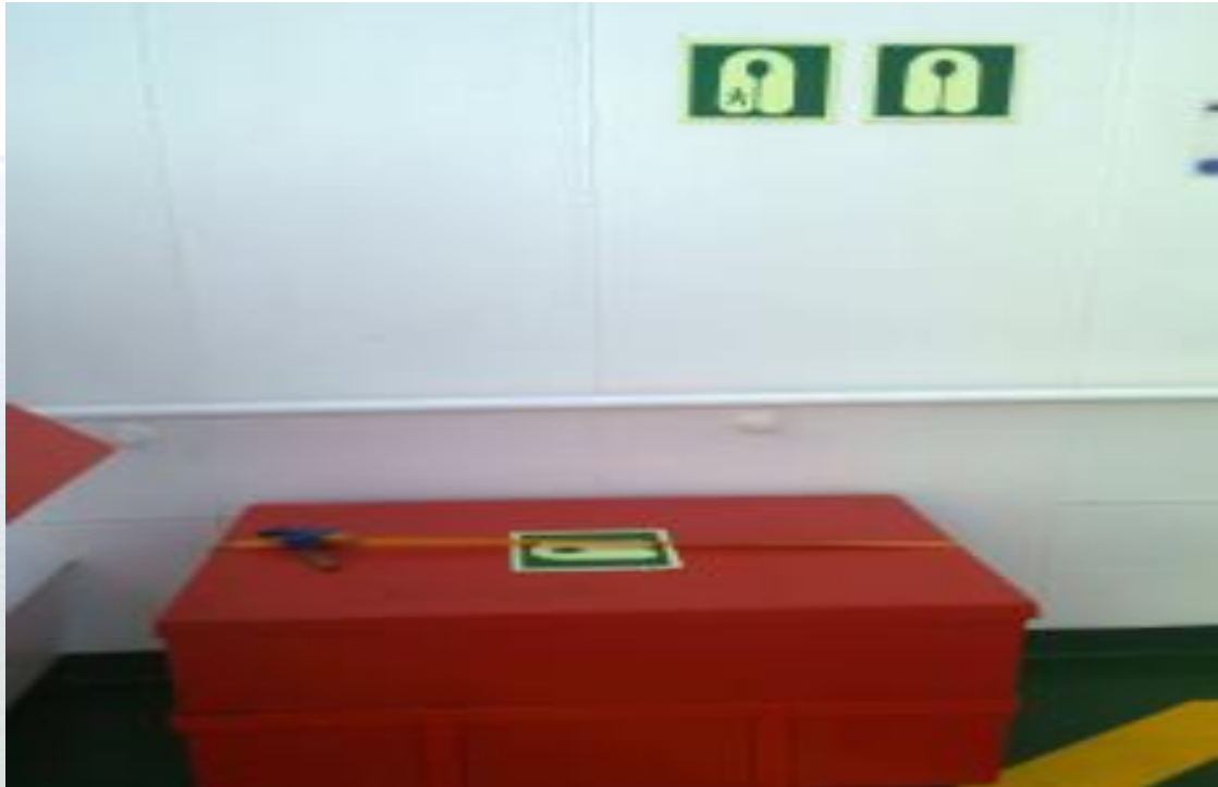
Ilustración 1374. Caja de estiba de chalecos salvavidas de la cubierta 7, situada en el punto de reunión de estribor. Trabajo de campo.
