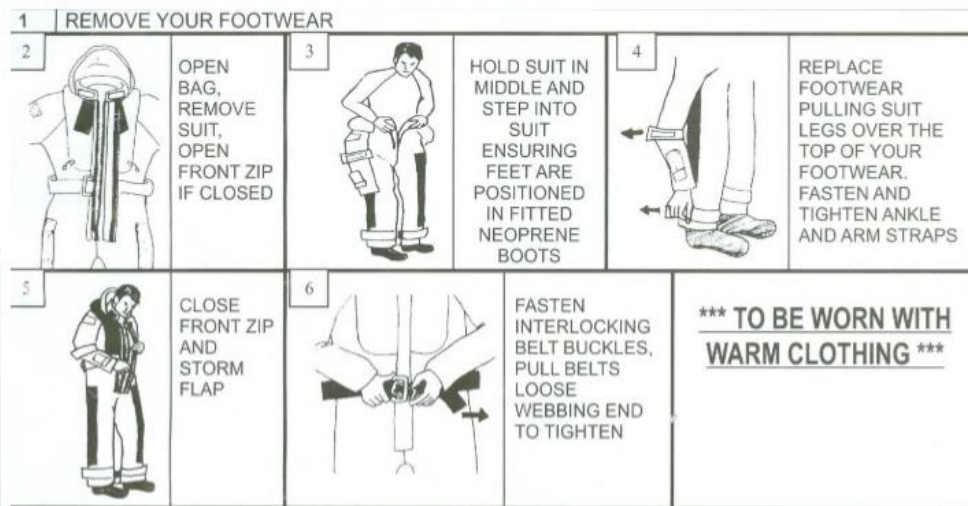
Ilustración 14350. Presentación de la correcta puesta del traje de supervivencia. Manual del fabricante.
