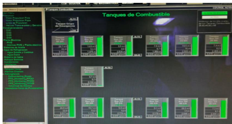
Ilustración 25. Ordenador central con teleniveles de los tanques de combustible. Fuente propia
