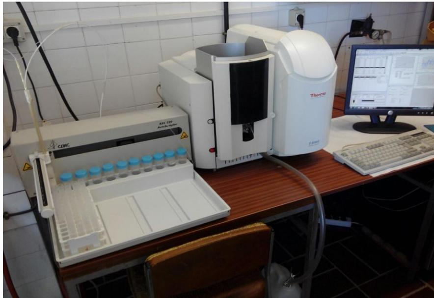
Foto 5.49. Espectrómetro de absorción atómica.
