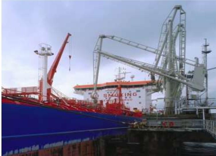
*Ilustración 18. Operación realizada con hard arm. Fuente: [https://commons.wikimedia.org/wiki/File:Marine\\_Loading\\_Arm\\_KLE.jpg](https://commons.wikimedia.org/wiki/File:Marine_Loading_Arm_KLE.jpg)*
