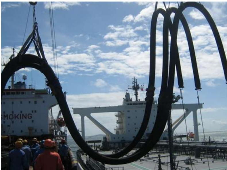
Ilustración 17. Mangueras de carga flexibles. Fuente: <http://zebungmarinehose.es/1-1-3-oil-suction-discharge-hose/220119>
