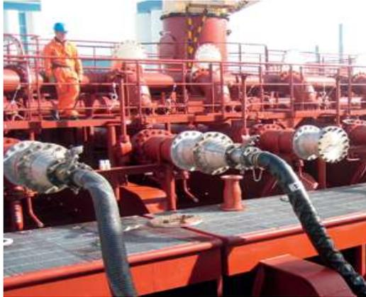
Ilustración 13. Manifold de carga. Fuente: <http://www.framo.com/default.aspx?pageld=26>
