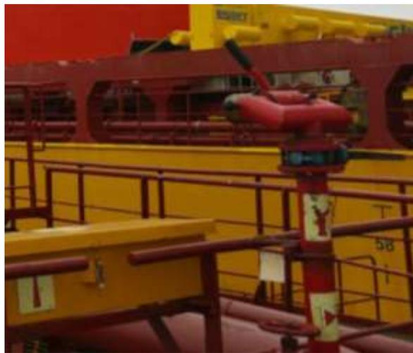
*Ilustración 26. Sistema fijo de espuma. Fuente: Elaboración propia*
