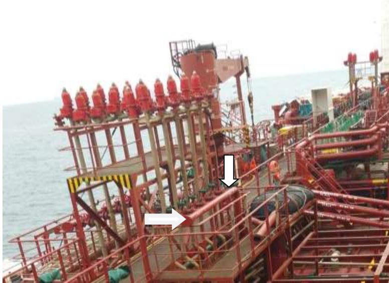
Ilustración 12. Línea de retorno de gases. Fuente: Elaboración propia
