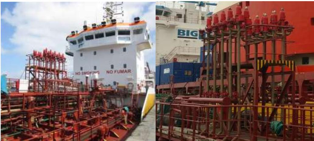
Ilustración 11. Válvulas P/V. Fuente: Elaboración propia
