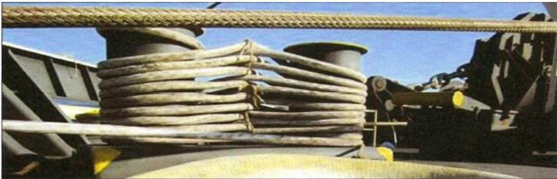
Figura 51: Línea de amarre aseguradas de una forma adecuada. Fuente: [28]
