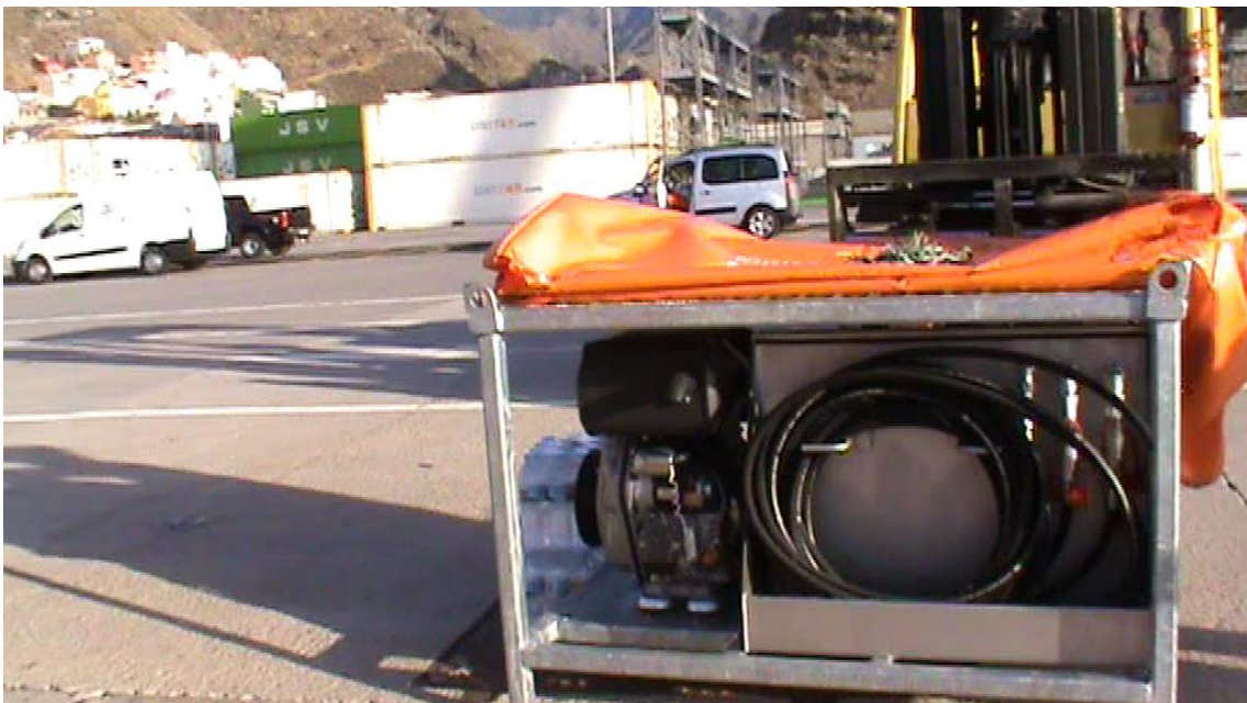
Figura 34: Unidad de energía hidráulica. Fuente: [28]
