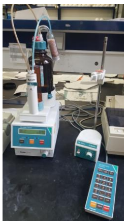
Figura 18. Valorador automático 716 DMS Titrino.
