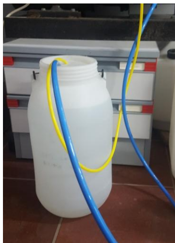
Figura 13. Tanque de alimentación conectado a la celda SEPA CF II.
