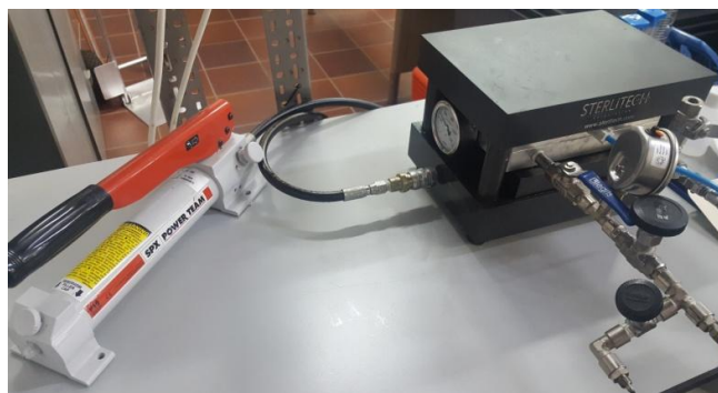
Figura 11. Bomba de mano hidráulica de la celda SEPA CF II.
