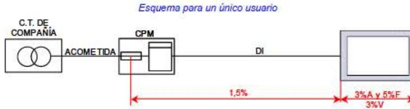
Figura 1: Caída de tensión según el esquema de un único usuario
