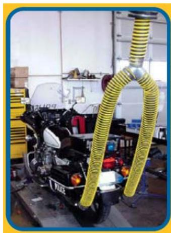
**Figura 87: Dispositivo extracción de gases de doble escape**
