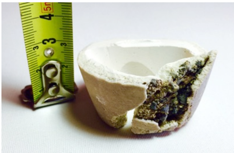
28. Vista en ángulo de 45º del corte y sección de la base de la pieza extraída del molde PLA formada en 3 meses y 15 días. (Corresponde a imagen 29 y 30).
