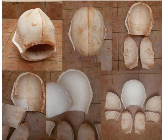
Molde a piezas de escayola para reproducción múltiple por apretón. 4
