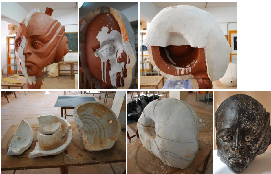
Molde perdido divisible con placas de latón y vaciado en resina de poliéster. 3
