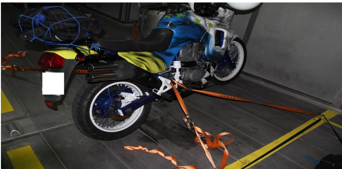
Ilustración 28. Ejemplo de trincaje de moto. Fuente: Trabajo de campo.
