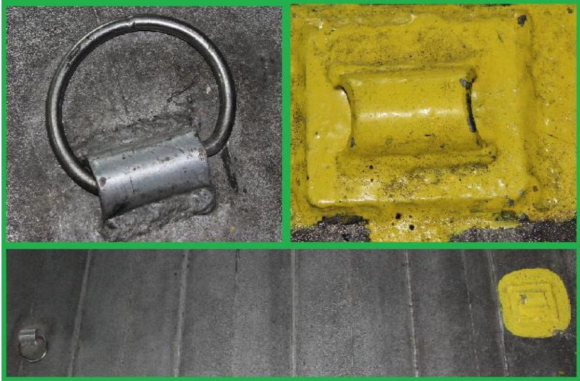
Ilustración 14. Anillas de trincaje y media caña pequeña. Fuente: Trabajo de campo.
