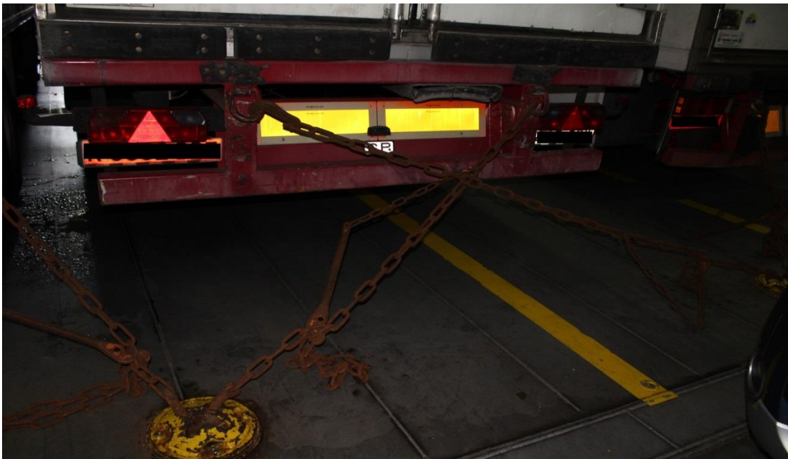
Ilustración 22. Ejemplo de trincaje con cadenas en plancha. Fuente: Trabajo de campo.
