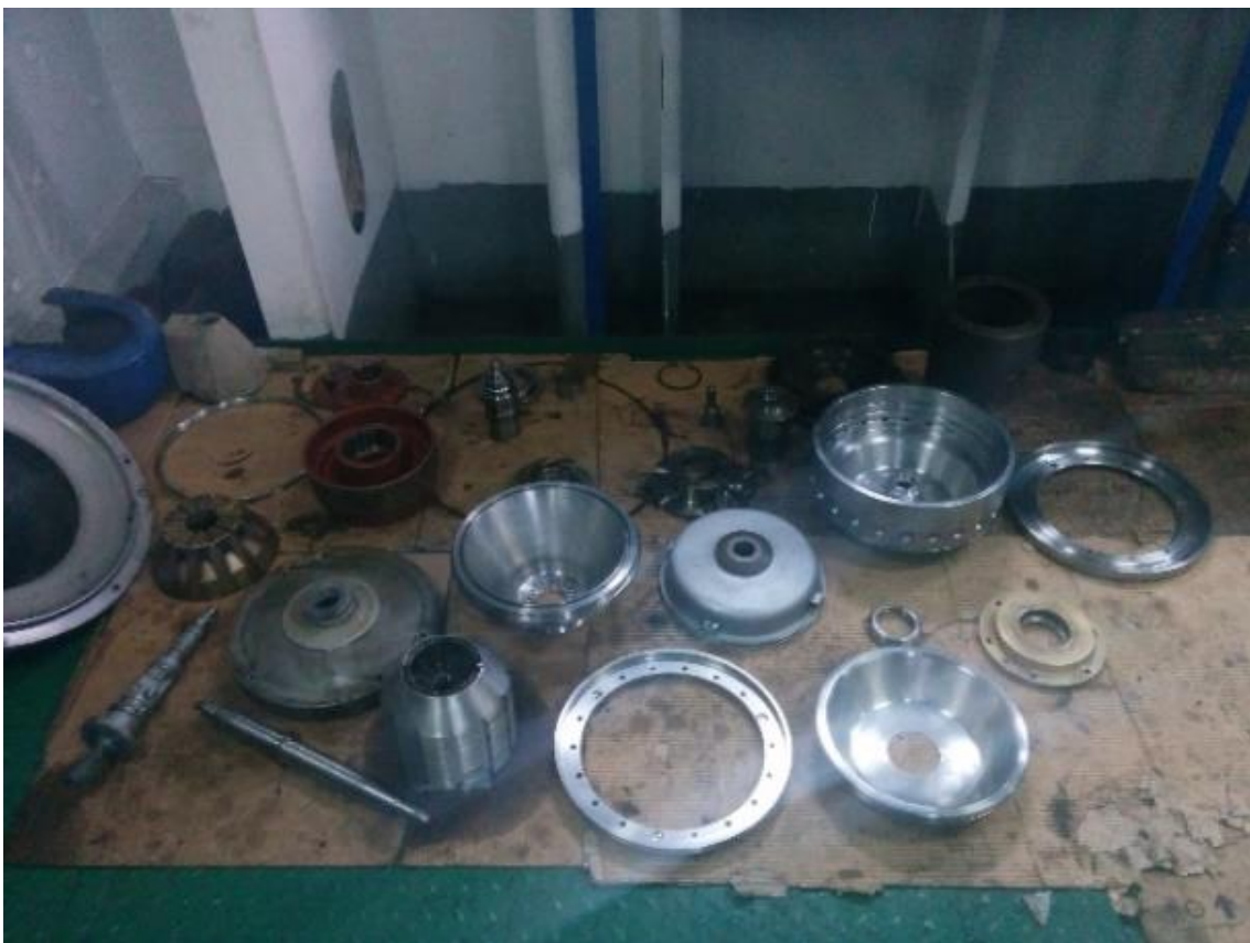
Ilustración 57 - Desmontaje y limpieza de las piezas de la depuradora
