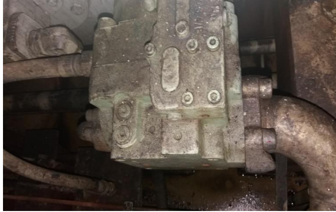
Ilustración nº 65 Bomba hidráulica acoplada al motor de babor. Fuente: Elaboración propia.
