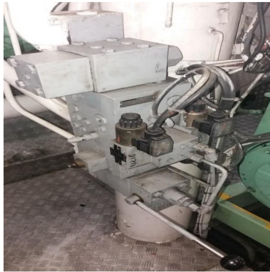
Ilustración n° 67 Accionamiento de la sala de máquinas de la Maquinilla de popa del VB Canarias. Fuente: Elaboración propia.
