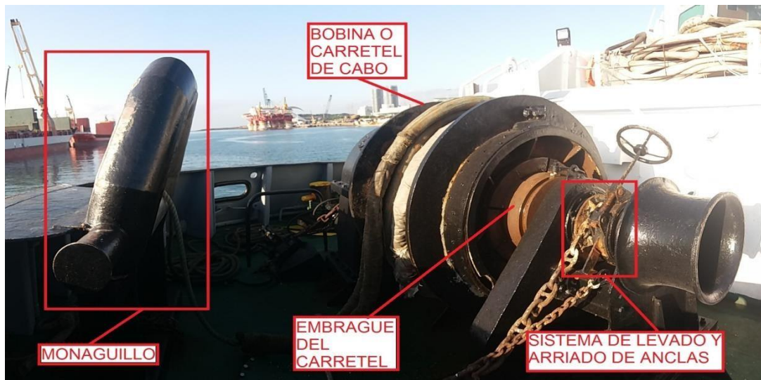
Ilustración n° 25 Maquinilla o chigre de proa del VB Tenerife. Fuente: Elaboración propia
