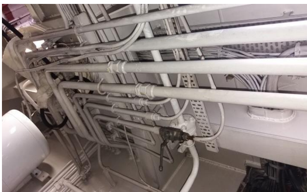
Ilustración nº 52 Tuberías de los mandos de puente de las maquinillas. Fuente: Elaboración propia.
