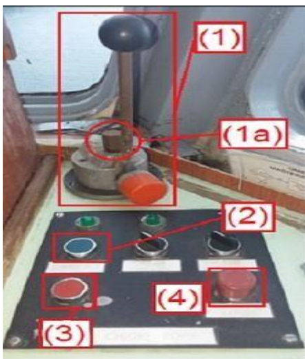
Ilustración n° 37 Mando de puente de la maquinilla de popa Fuente: Elaboración propia
