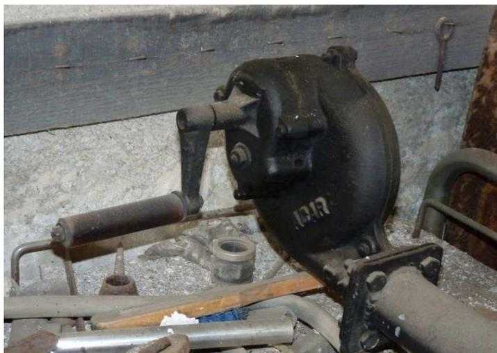
*Ilustración 73: Ventilador de manivela.*
