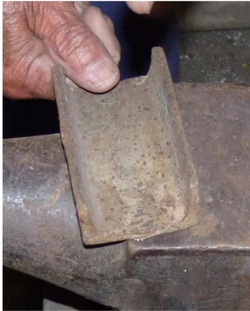
*Ilustración 49: Tas en forma de U, vástago dentro del orificio del yunque.*
