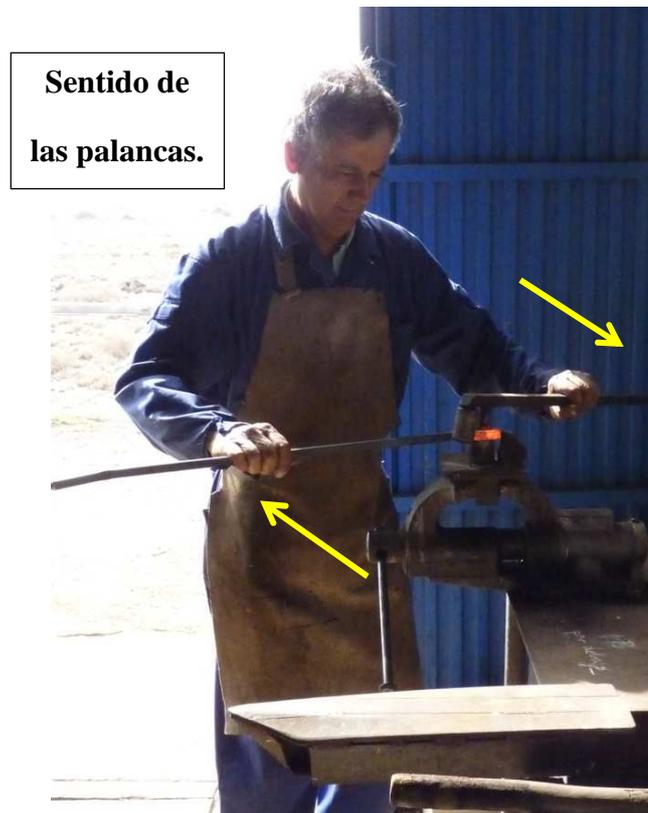
*Ilustración 103: Doblando el hierro con el perfil de doblado y la palanca.*
