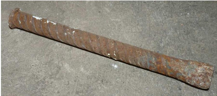
*Ilustración 26: Cortahierro, hecho de acero de ferralla.*
