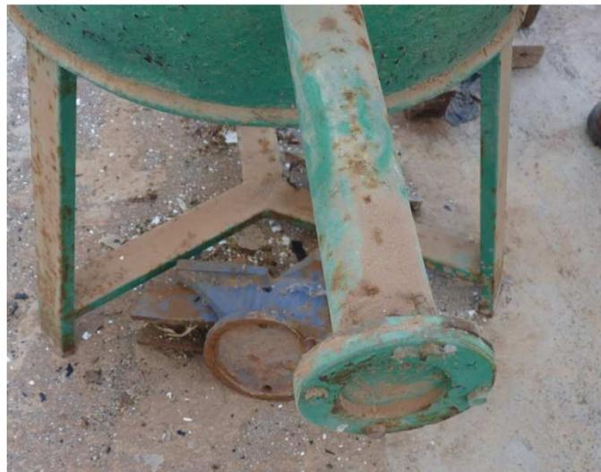
*Ilustración 35: Brida de cierre, para limpiar las cenizas.*
