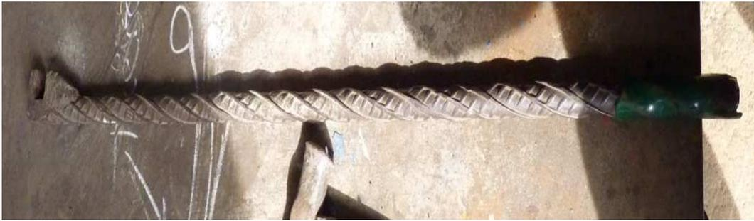
*Ilustración 54: Grifa artesanal, fabricada con hierro corrugado.*
