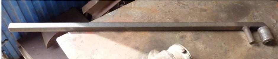
*Ilustración 101: Palanca de perfil de doblado con rodillo.*
