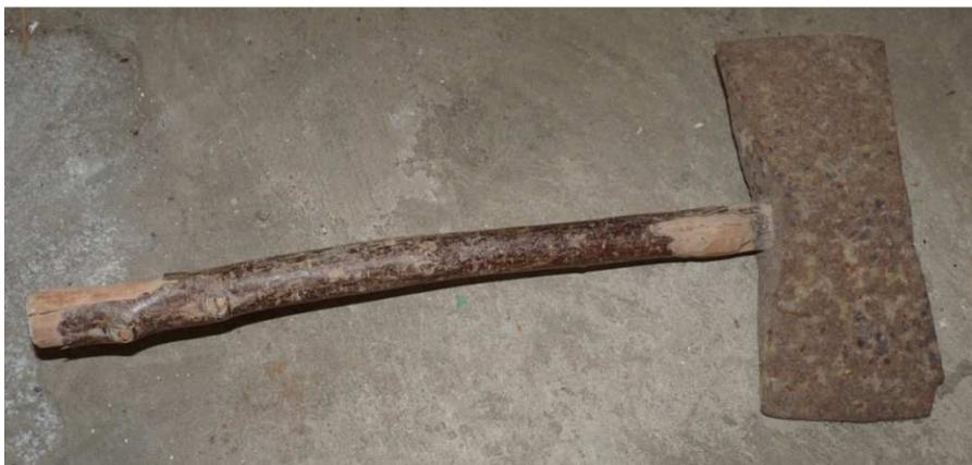
*Ilustración 25: Herramienta de corte para cantería, hechas de una sola pieza.*
