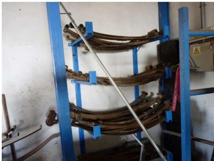
*Ilustración 21: Ballestas utilizadas para forja.*
