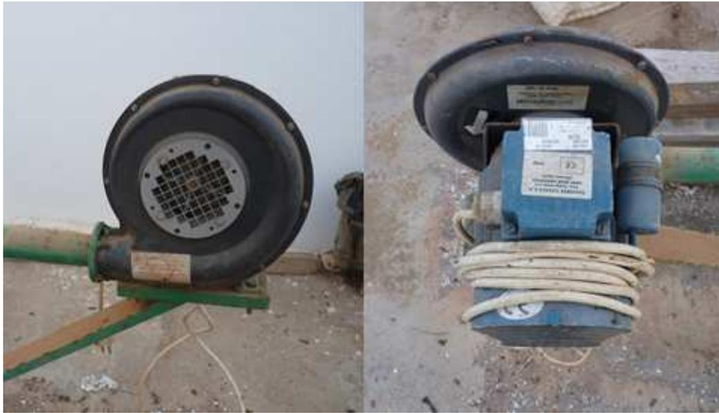
*Ilustración 37: Electroventilador de la fragua.*
