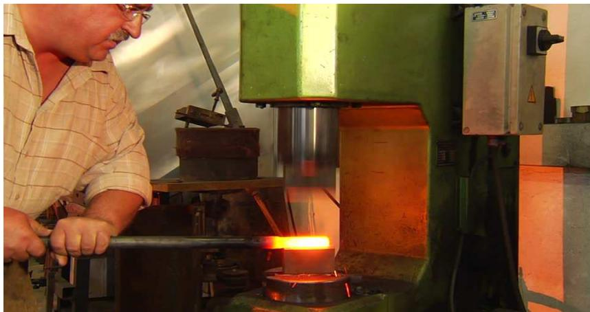
*Ilustración 2: Forja mecánica.*
