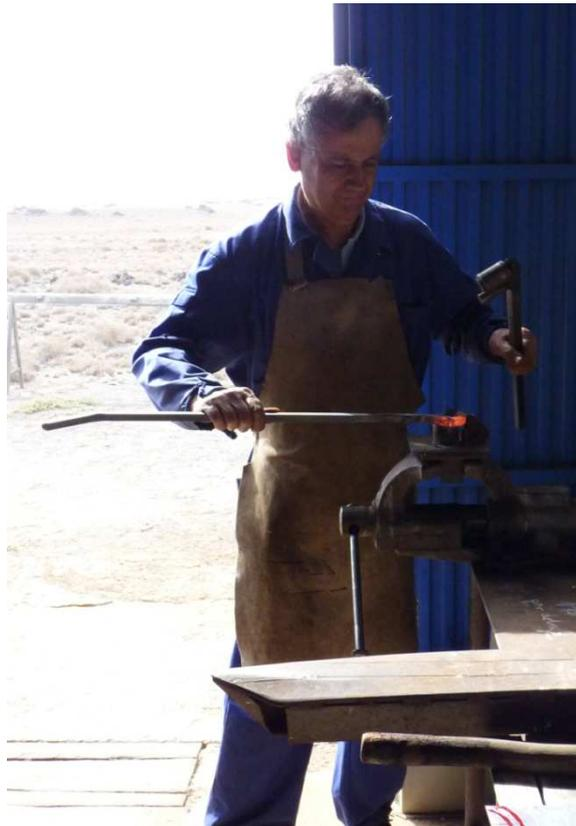
*Ilustración 102: Colocando el hierro en el perfil.*
