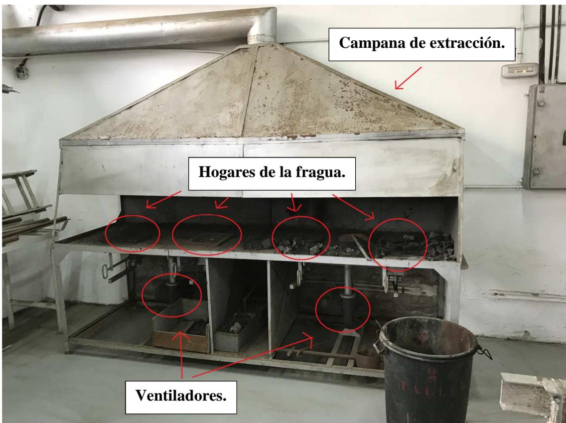
*Ilustración 145: Hogares, ventiladores y campana de extracción.*
