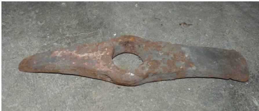
*Ilustración 24: Herramienta de corte para cantería, hechas de una sola pieza.*
