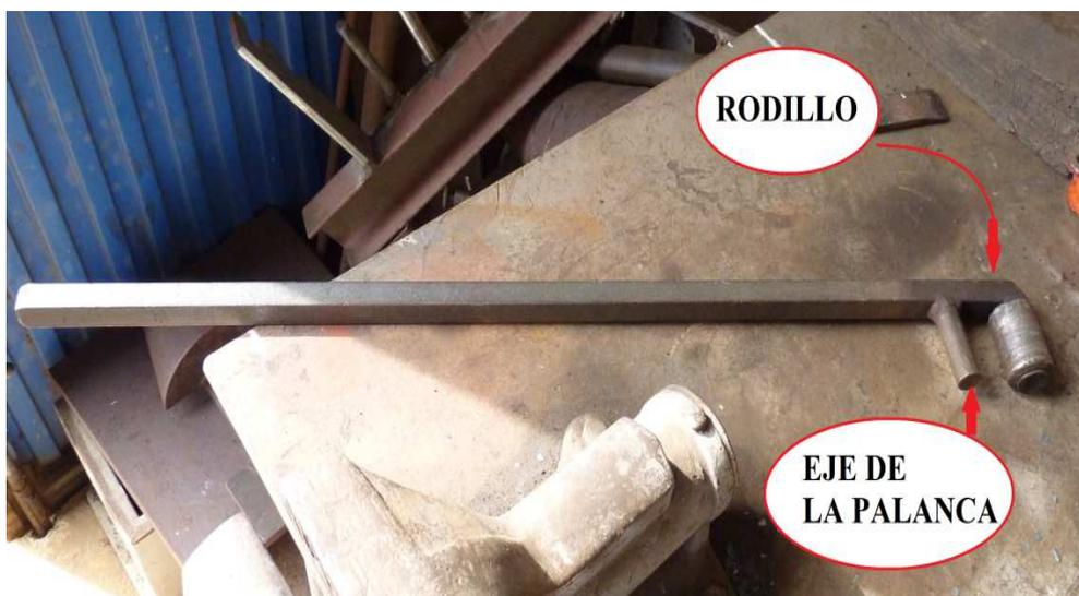
*Ilustración 57: Palanca del perfil de doblado con rodillo.*
