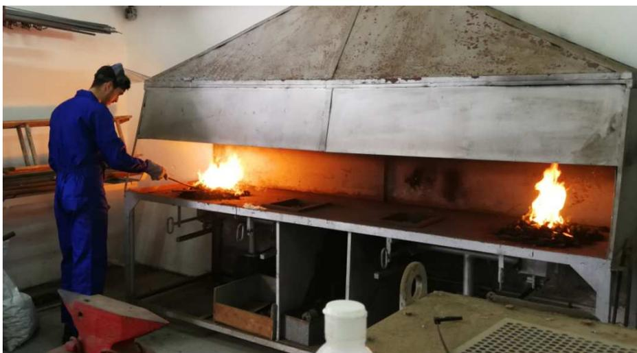
*Ilustración 155: Controlando la temperatura del hierro.*
