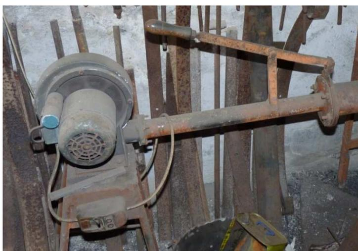
*Ilustración 74: Ventilador eléctrico, con llave de aire.*
