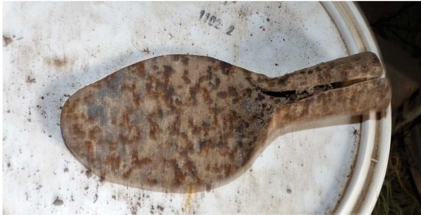
*Ilustración 29: Plantón, hecho de una ballesta y de una sola pieza.*
