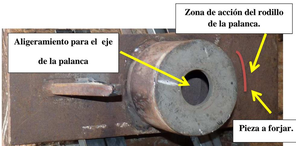
*Ilustración 56: Perfil de doblado con eje.*
