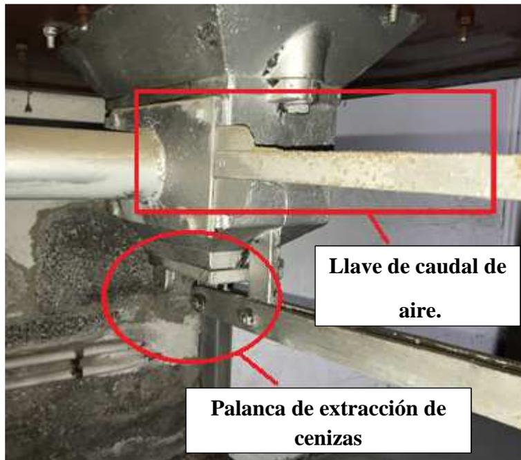
*Ilustración 147: Llave de caudal de aire y palanca de extracción de cenizas.*
