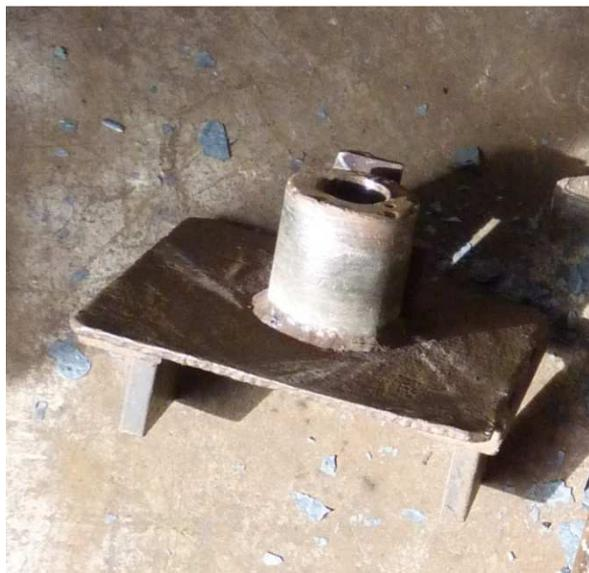
*Ilustración 100: Perfil de doblado con eje.*
