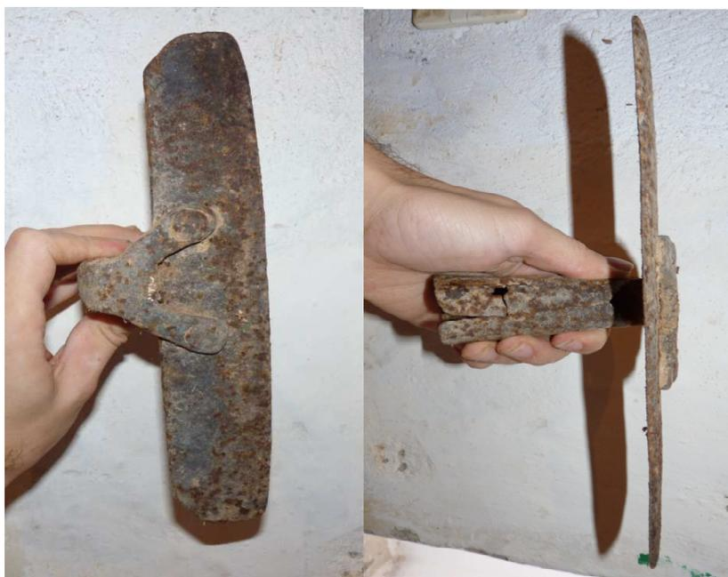
*Ilustración 22: Escardillo, hecho con hoja de muelle y unido con remaches.*
