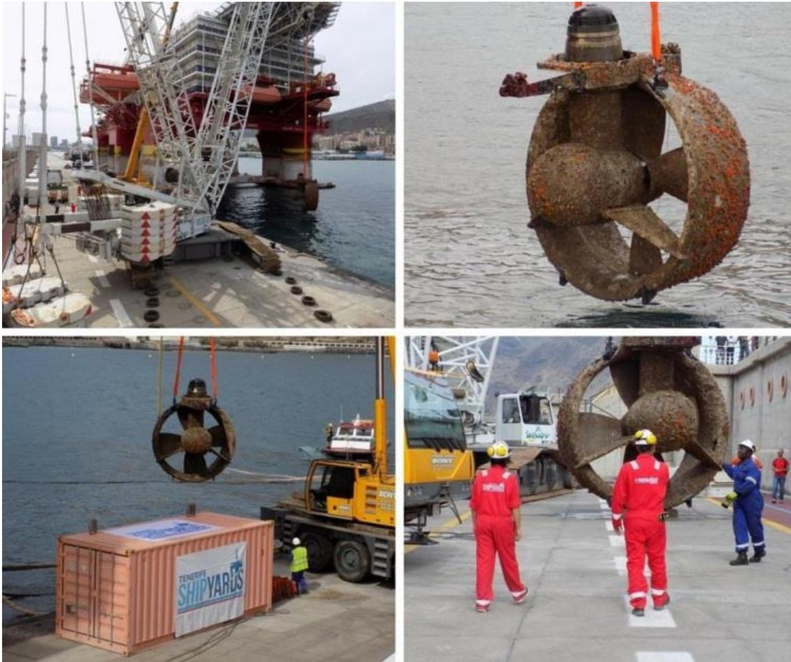
Ilustración 31. Extracción de propulsor azimutal de la plataforma Floatel Reliance realizada en la dársena de Anaga. Fuente: (19)
