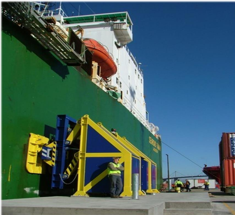
(10) Unidades MoorMaster 400 trabajando en conjunto.
