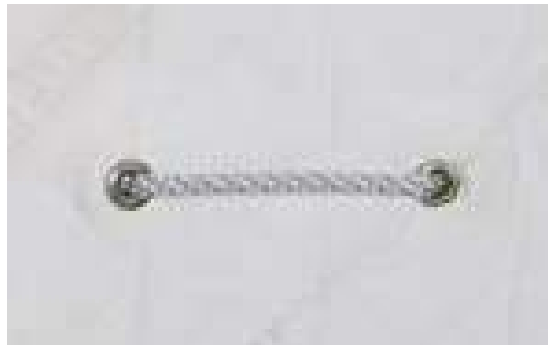
Figura 39: Resultado de la unión entre las tachuelas y el board – buttonhole
