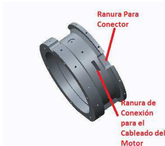
Figura 39 Ranuras de conexión y para la ubicación del conector de potencia
