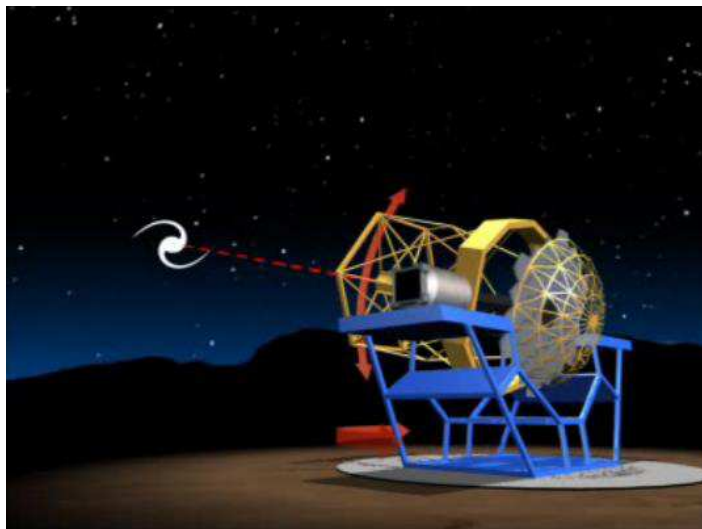
Figura 12 Movimientos de la estructura del telescopio en la operación de apuntado
