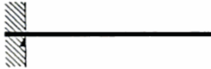
Figura 1 Viga en Voladizo
