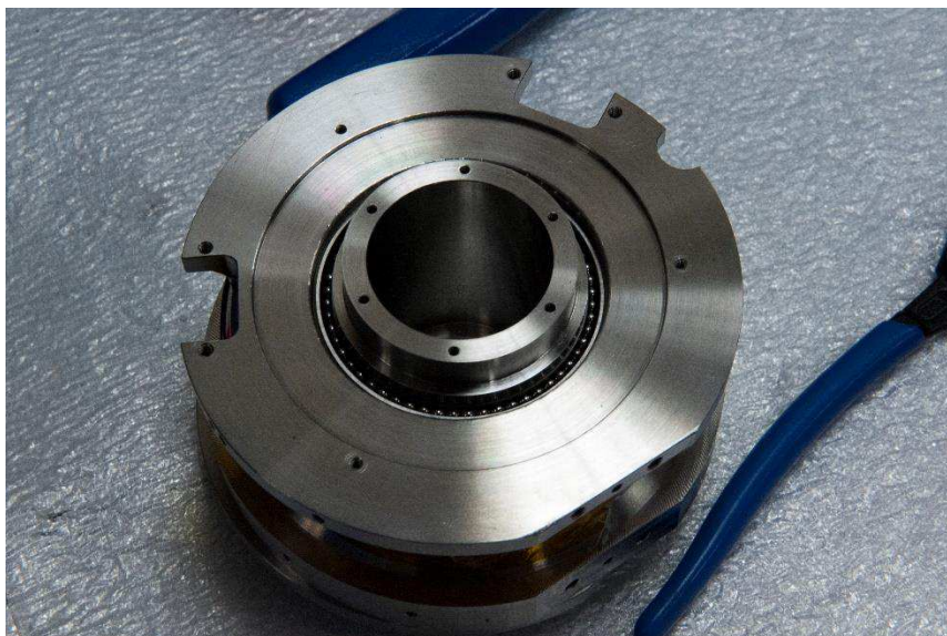
Figura 56 Parte posterior del mecanismo en los instantes previos a la colocación del codificador
