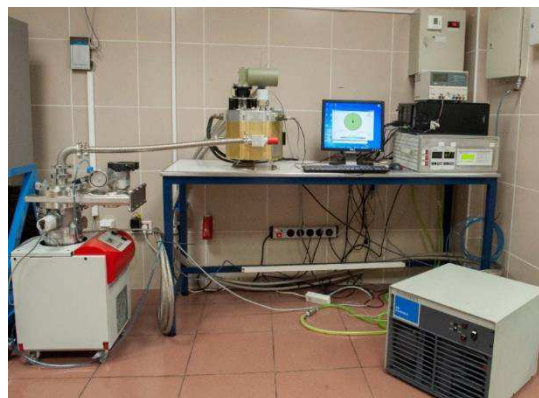
Figura 18 Montaje experimental en el interior del criostato. En la pantalla del ordenador se aprecia el software de medición.
