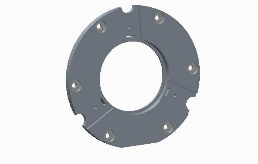
Figura 37 Interfaz del sistema con el diseño inicial de ranuras y aperturas para las PCI
