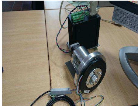
Figura 17 Montaje para la caracterización en caliente del encoder. Éste está conectado a un controlador que mueve un motor paso a paso y obtiene las lecturas pertinentes
