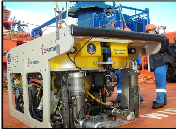
**Ilustración 96: Robot submarino.**
