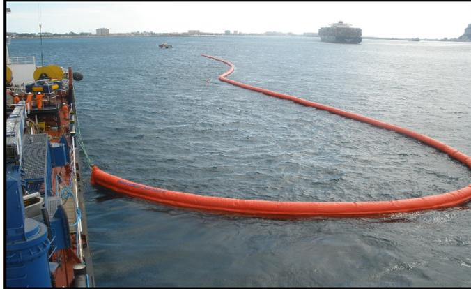
**Ilustración 35: Barrera de Flotador sólido. (FUENTE: <http://www.ecoestrecho.com/actualidad/reportajes/un-petrolero-contra-la-contaminacion>)**
