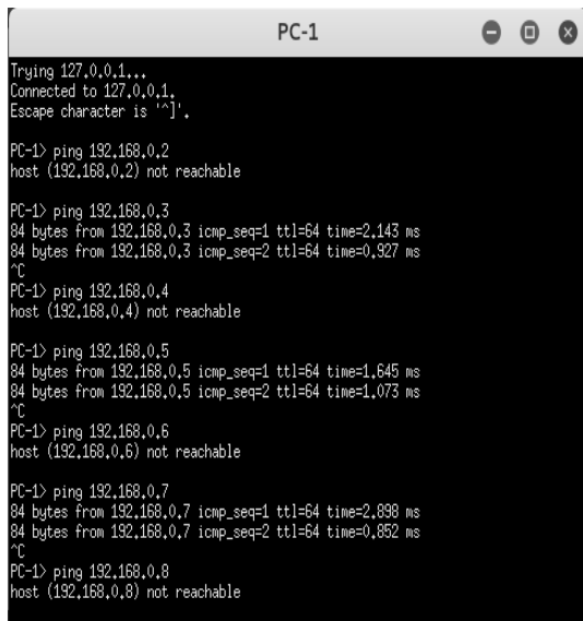
Figura 24: Resultado Prueba 2 KV-SWITCH
