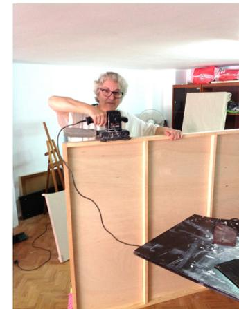
Imagen nº 26.- Lijado del bastidor.
