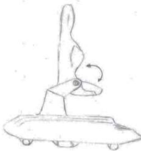
Figura 72. Asiento con giro asistido por actuadores rotativos.
