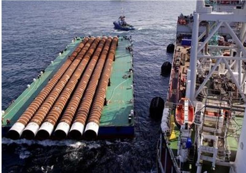
Ilustración 46. Transporte de pilotes en una barcaza (es la misma barcaza en la que se transportó el jacket).
