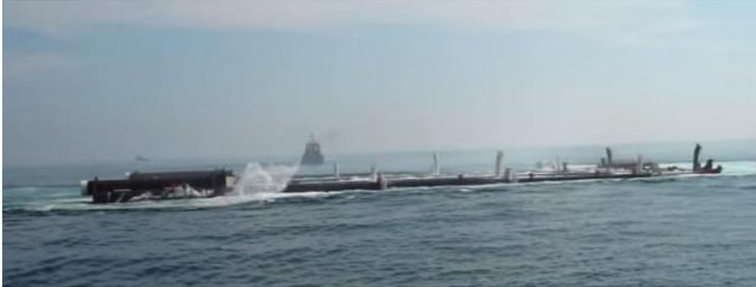
Ilustración 39. Jacket a flote. Fuente: [www.youtube.com/watch?v=WnwgFjnWttg](http://www.youtube.com/watch?v=WnwgFjnWttg)
