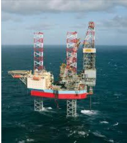
Ilustración 6. Plataforma jack-up. Fuente: [www.atmosferis.com](http://www.atmosferis.com)
