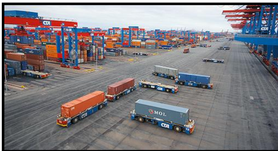
Ilustración 32: Nuevos sistemas de automatización para el movimiento de contenedores. (Fuente: Terex, en línea)
