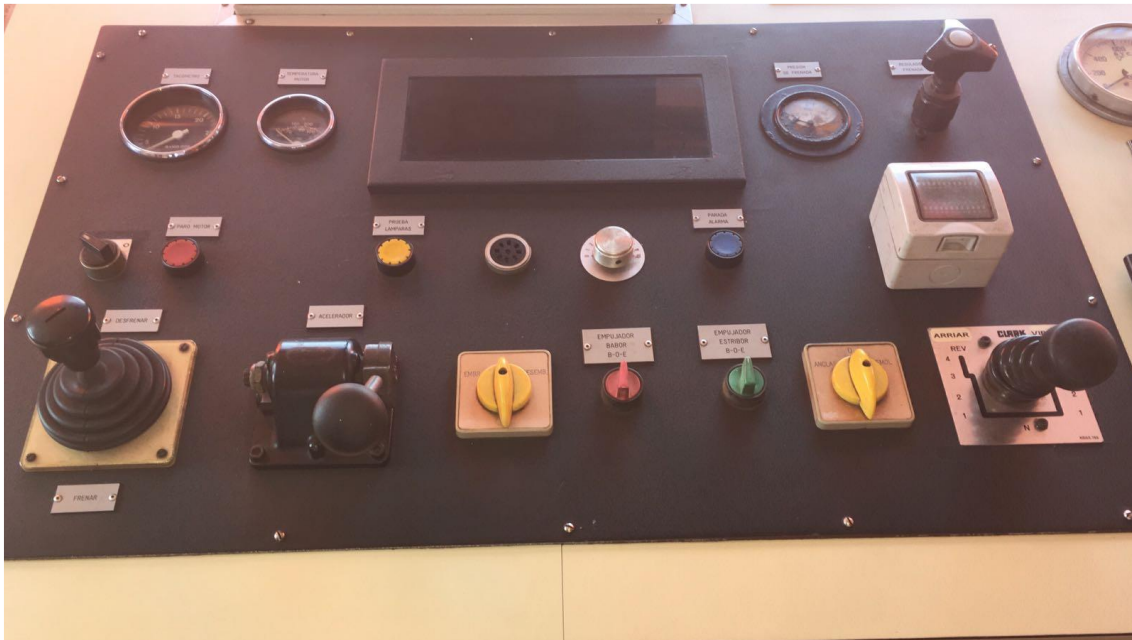
Ilustración 33: Duplicado de control de la maquinilla
