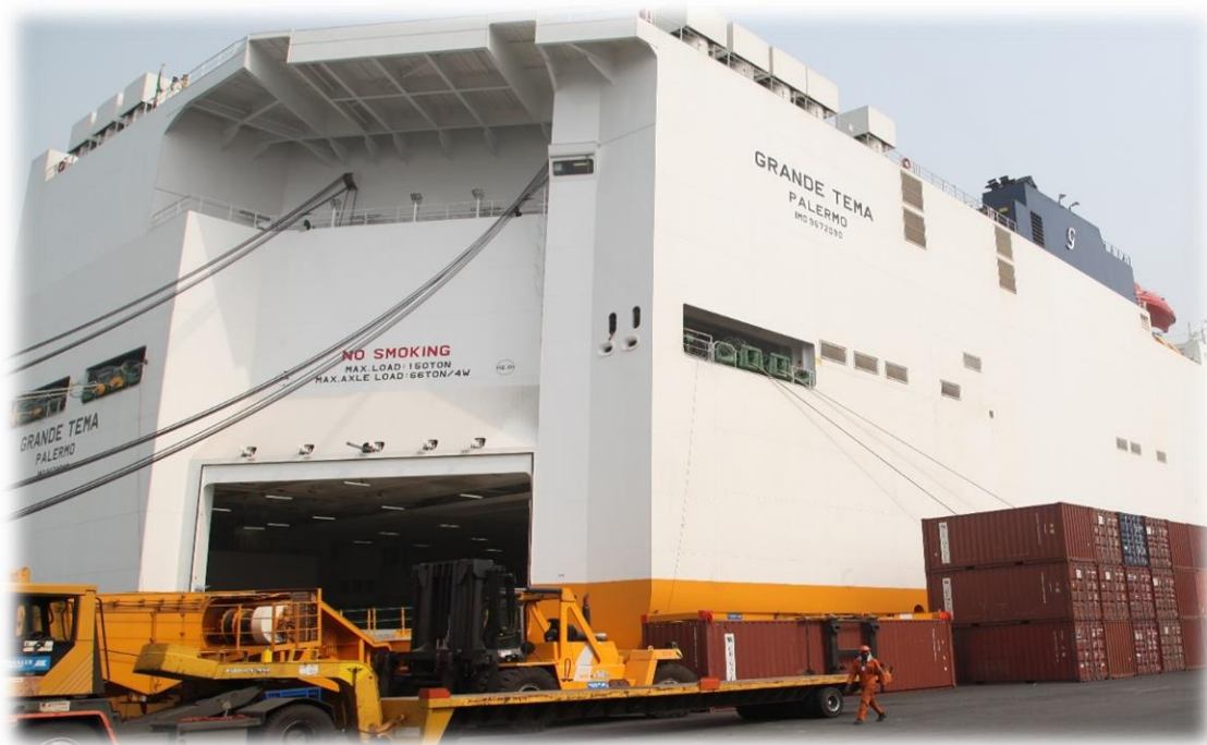
Imagen 4. Buque RO-RO Grande Tema en operativa de descarga, Durban Sur África 2017.
