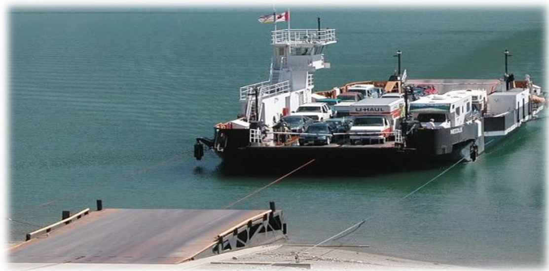
Imagen 10. Ferry impulsado por cable en operativa.
