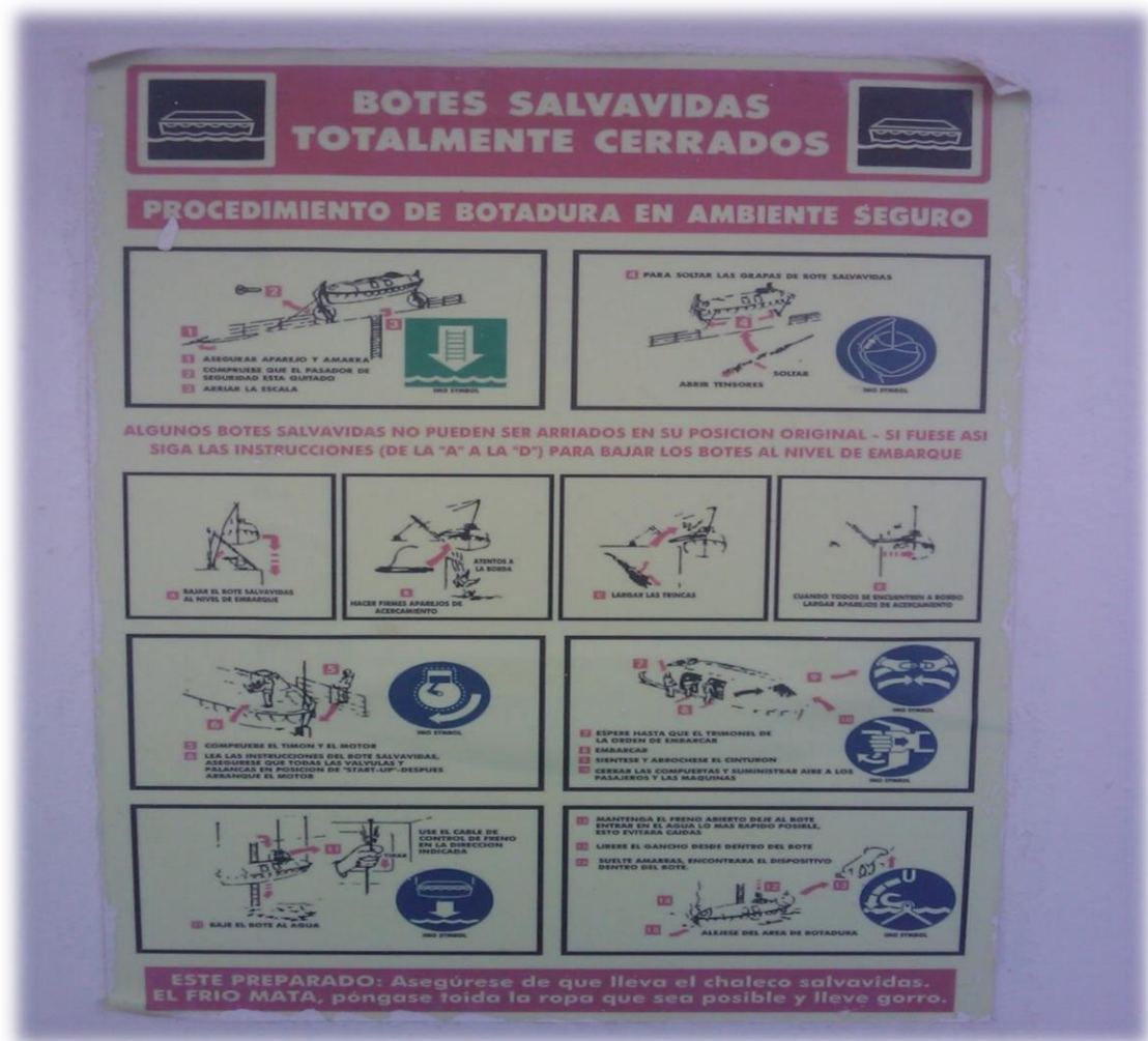
Imagen 36. Guía rápida de arriado de botes buque Volcán de Taburiente.
