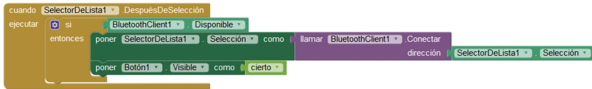
Figura 22: Bloque que establece la conexión Bluetooth.
