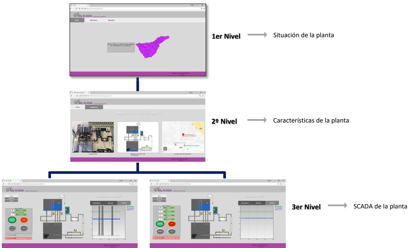
Figura 42: Arquitectura del SCADA
