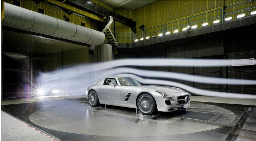
Figura 10: interior de un túnel de viento con un vehículo eléctrico. En él se le somete a pruebas para ajustar su coeficiente aerodinámico.
