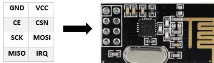
Figura 27. Pines asociados al transceptor NRF2401.
