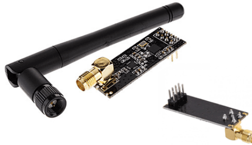
Figura 18. Módulo NRF2401. Versión con antena externa y amplificador.
