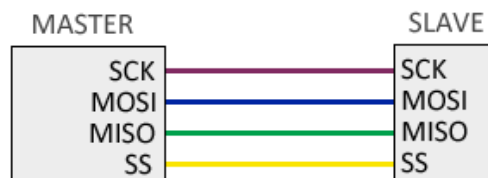
Figura 15. Estructura general del bus SPI.
